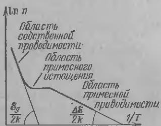
Рис. 5. Зависимость логарифма концентрации электронов от обратной температуры
