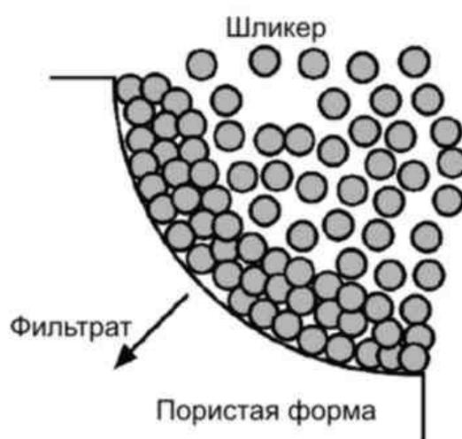
Рис. 24. Схема шликерного литья
