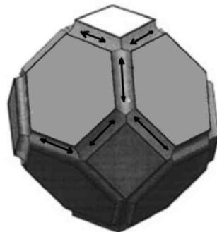
Рис. 38. Каналы пор, образующиеся на средней стадии спекания
