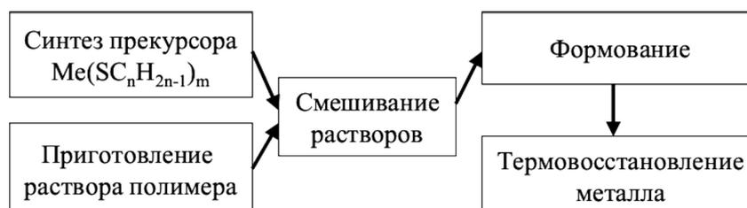
Рис. 95. Схема синтеза металл – полимерного композита термовосстановлением металла в полимере
