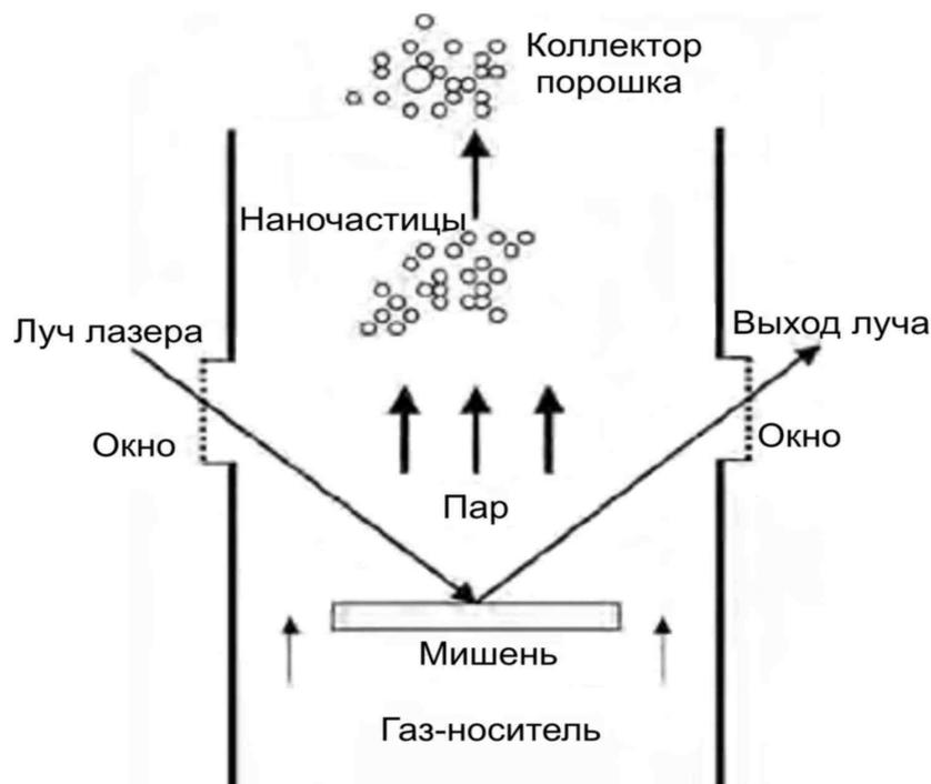
Рис. 22. Схема установки для лазерной абляции
