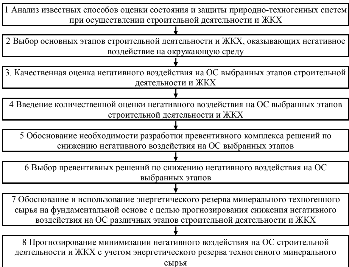
Рисунок 1 – Превентивный метод прогноза минимизации негативного воздействия на окружающую среду строительной деятельности и ЖКХ
