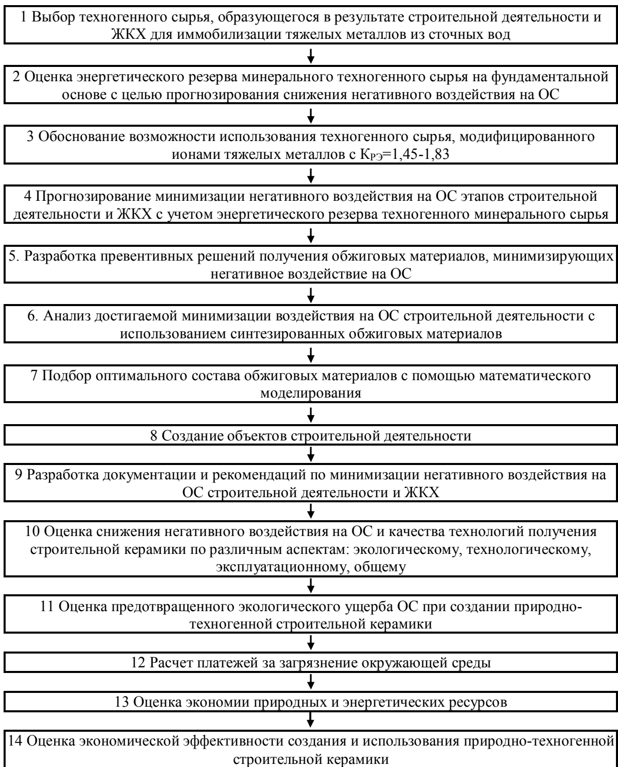
Рисунок 13 – Система превентивных методов защиты природно-техногенных систем и управления ими при осуществлении строительной деятельности с применением природно-техногенных керамических материалов с модифицированным техногенным сырьем
