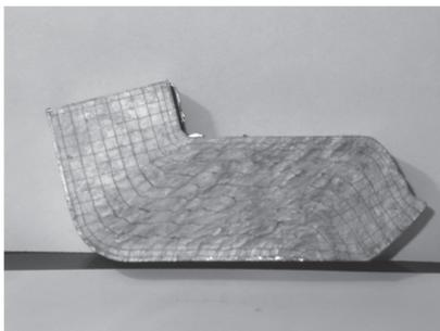
Рис. 6.29. Внешний вид образцов с деформированной сеткой, полученных РКУ-прессованием с различными смазками:
