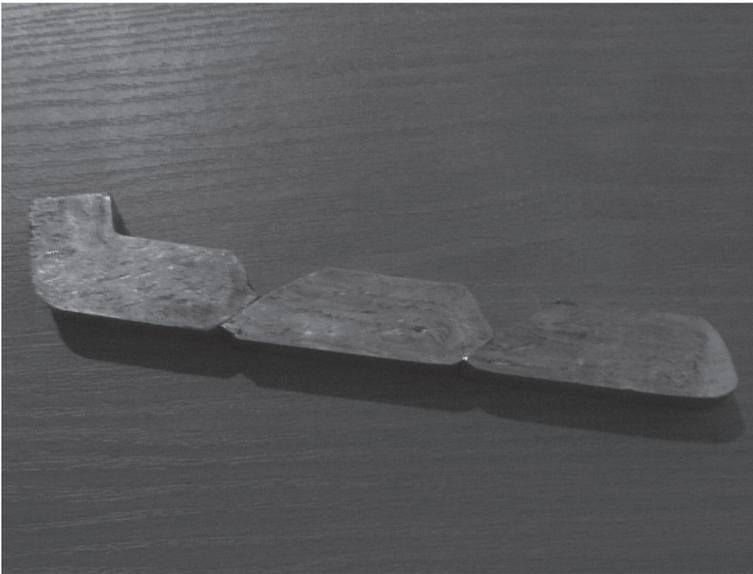
Рис. 6.23. Форма образцов после непрерывного РКУ-прессования при различных типах смазки:
