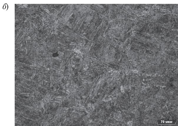
Рис. 2.5. Режим трехстадийной деформации с последующим термоциклированием (a) и структура обработанного металла (б).
