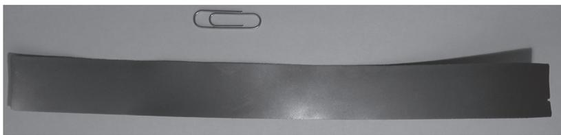
Рис. 5.9. Бериллиевая фольга толщиной 30 мкм, полученная методами ИПД.
