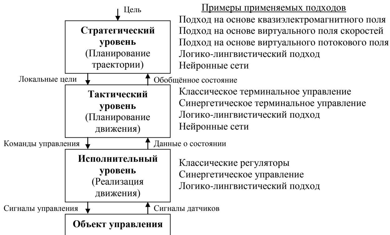
Рис. 1. Иерархическая система управления перемещением мобильного объекта
