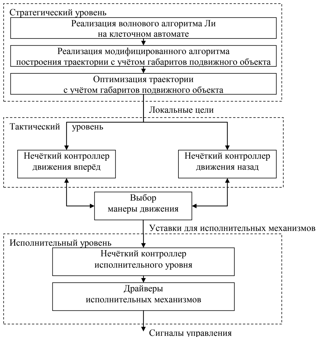
Рис. 3. Структура системы интеллектуального управления подвижным объектом
