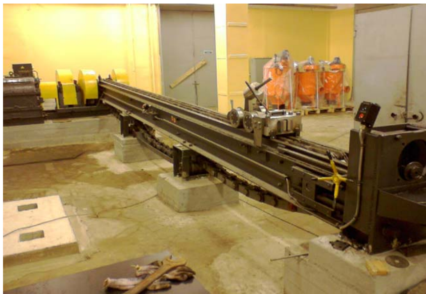
Рис. 3.2 Цепной волочильный стан
