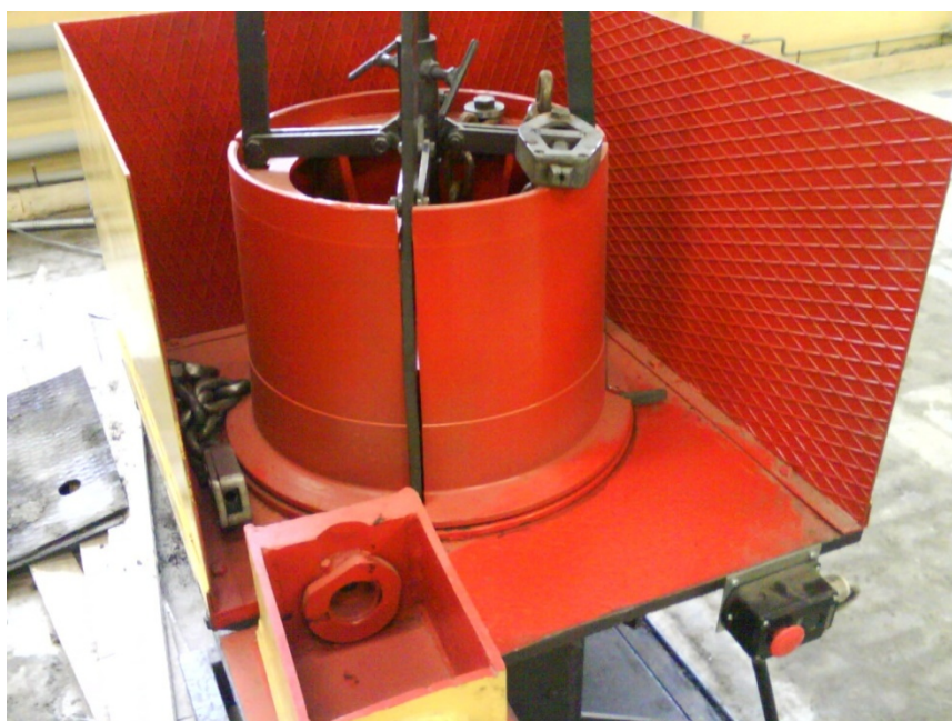
Рис.3.3 Волочильный стан барабанного типа
