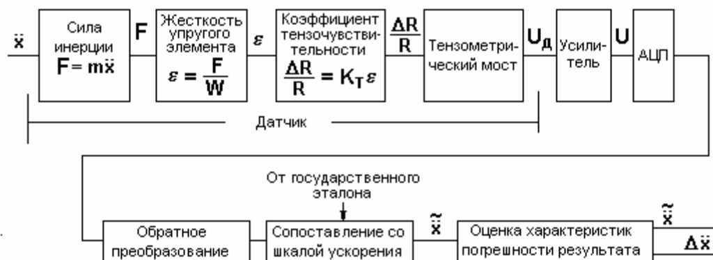
Рис. 36. Измерительные преобразования при измерении ускорения с помощью тензорезистивного датчика
