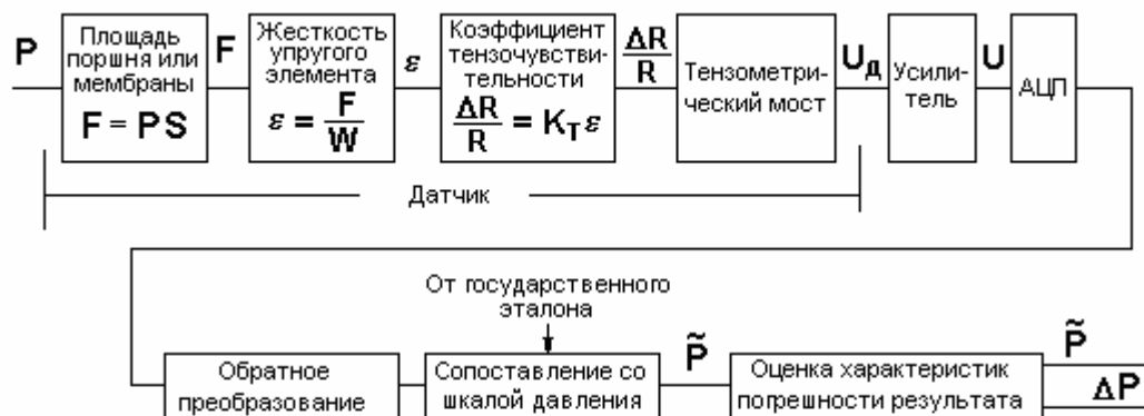
Рис. 38. Измерительные преобразования при измерении давления с помощью тензорезистивного датчика
