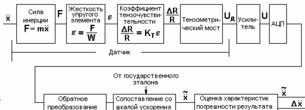
Рис. 63. Измерительные преобразования при измерении ускорения с помощью тензорезистивного датчика
