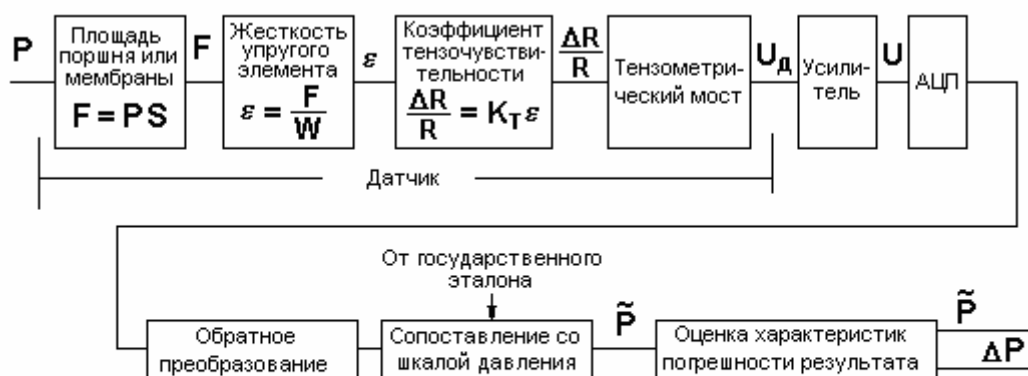
Рис. 65. Измерительные преобразования при измерении давления с помощью тензорезистивного датчика
