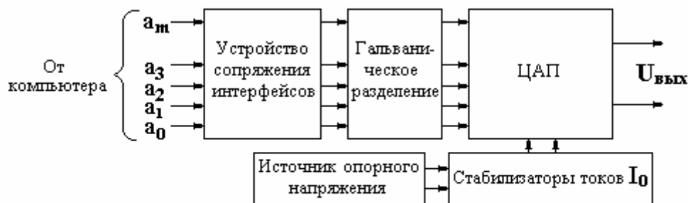
Рис. 45. Состав ЦАП, сопрягаемого с компьютером
