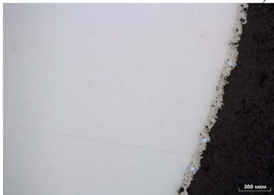
Рис.6. Поперечный шлиф образца после индукционной термообработки при мощности колебательного контура в 11,5 кВт. Масштаб а) 1:100 б) 1:1000
