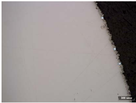
Рис.5. Поперечный шлиф образца до термообработки. Масштаб а) 1:100 б) 1:1000
