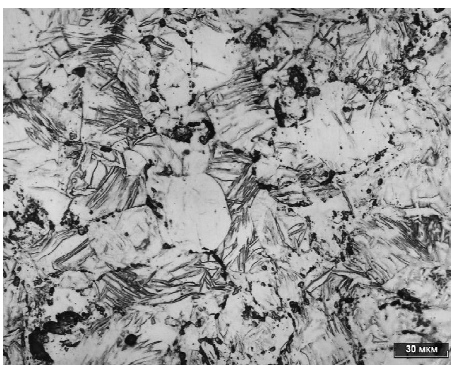
Рис. 9. Кривые пластического течения дистиллированного бериллия при температурах теплой деформации (а) и структура после деформации при температуре 500 °C, \epsilon = 80\% (б)
