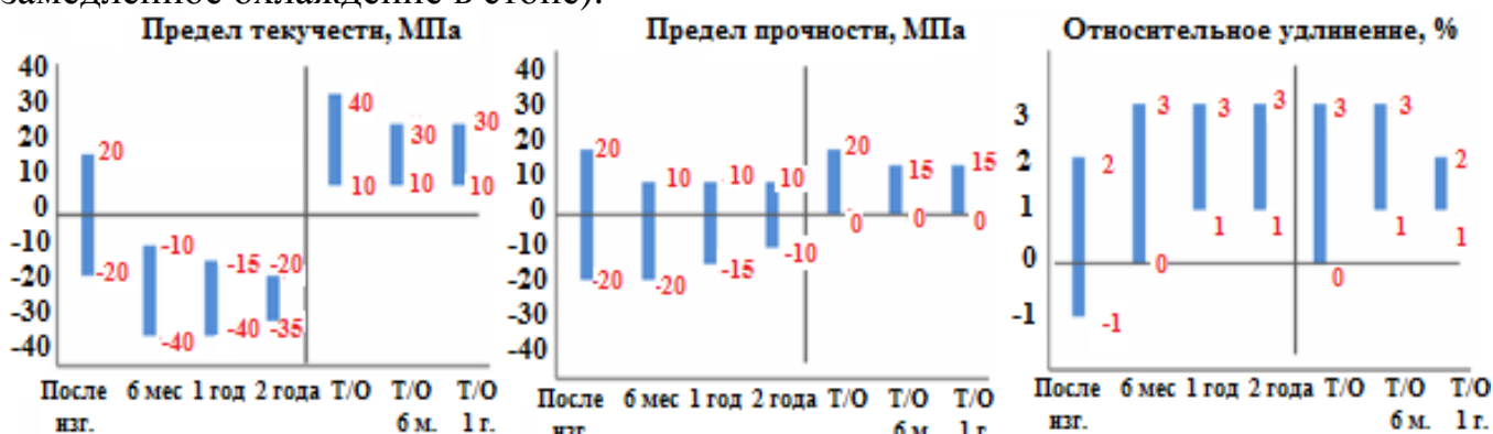
Рис. 11. Результаты испытаний образцов на растяжение стали К65.
