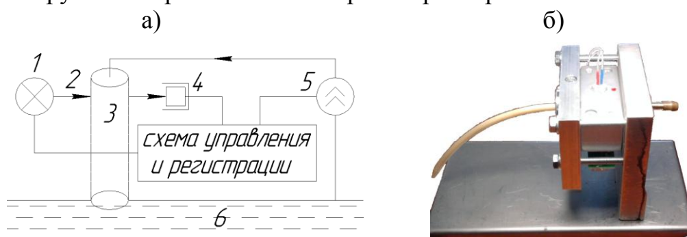
Рис.14. Принцип работы датчика механических примесей – а), и испытательный стенд – б).
