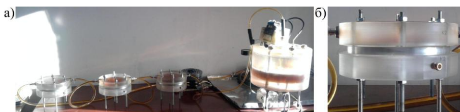
Рис.2. Общий вид испытательного стенда (а) и ячейки К-260 (б).
