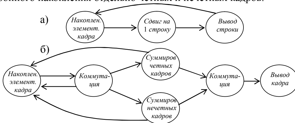
Рис. 5. Графы операций, проводимых в ФПЗС: а) временной задержки и накопления, б) синхронного накопления.
