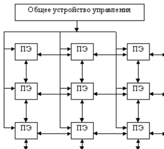
Структура матричной вычислительной системы "SOLOMON"
