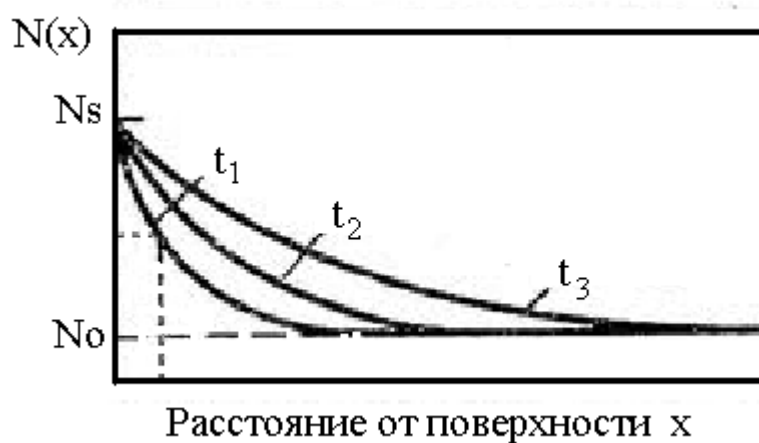
Рис. 2.8. Зависимость концентрации легирующей примеси от расстояния от поверхности в случае легирования из бесконечного источника.
