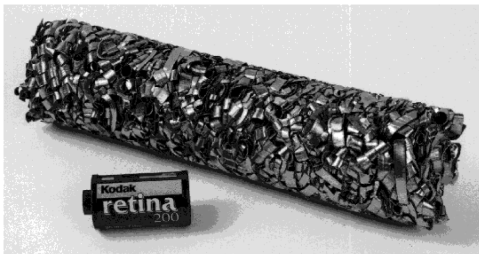
Рис. 2.а. Фотография длинномерного брикета из стружки титанового сплава 3М. Размер брикета: диаметр 53 мм, высота 210 мм; плотность 1,1 г/см 3 (пористость 75 %); масса 520 г
