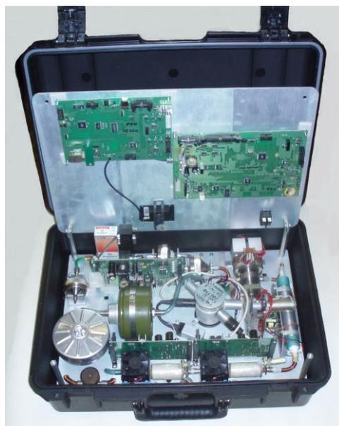
Рис. 60. Газоанализатор летучих карбониллов металлов.
