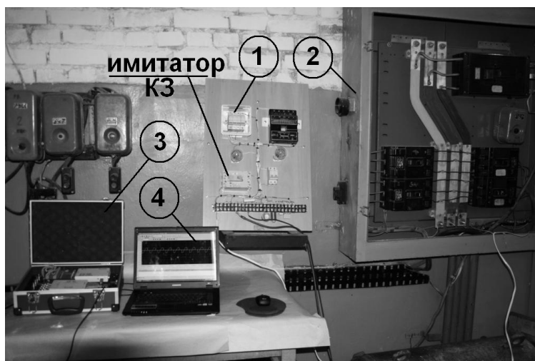
Рисунок 3 - Экспериментальный стенд для регистрации перенапряжений в действующей электрической сети
