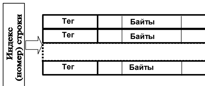
Рис. 4.17. Схема КЭШ памяти с прямым отображением.
