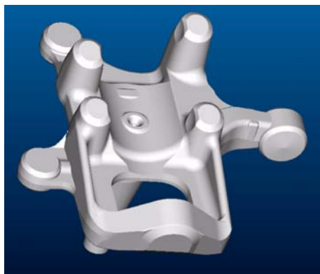
Рис. 8. Геометрическая модель поковки поворотного кулака в системе Pro-Engineer
