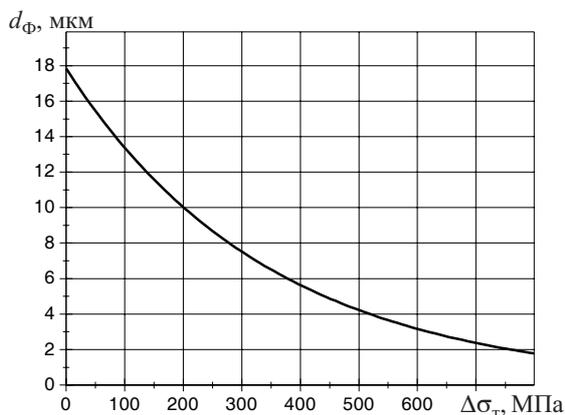
Рис. 6. Зависимость размера зерна феррита от остаточного деформационного упрочнения на момент фазового превращения при  $\Delta\sigma_{\phi n} = 280$  МПа ( $\Delta Q_{\phi n} = 2$  кДж/моль)
