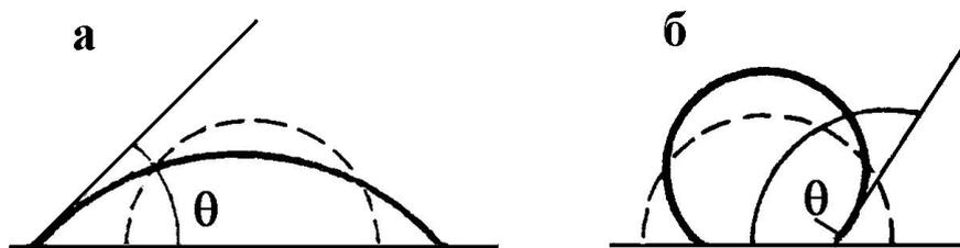
Рис. 4.6. Растекание капли на твердой поверхности:
