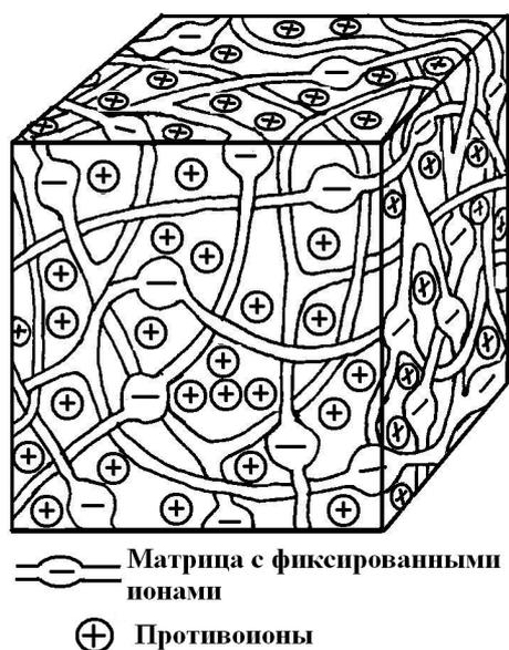
Рис. 4.33. Объемная модель ионита полимеризационного типа
