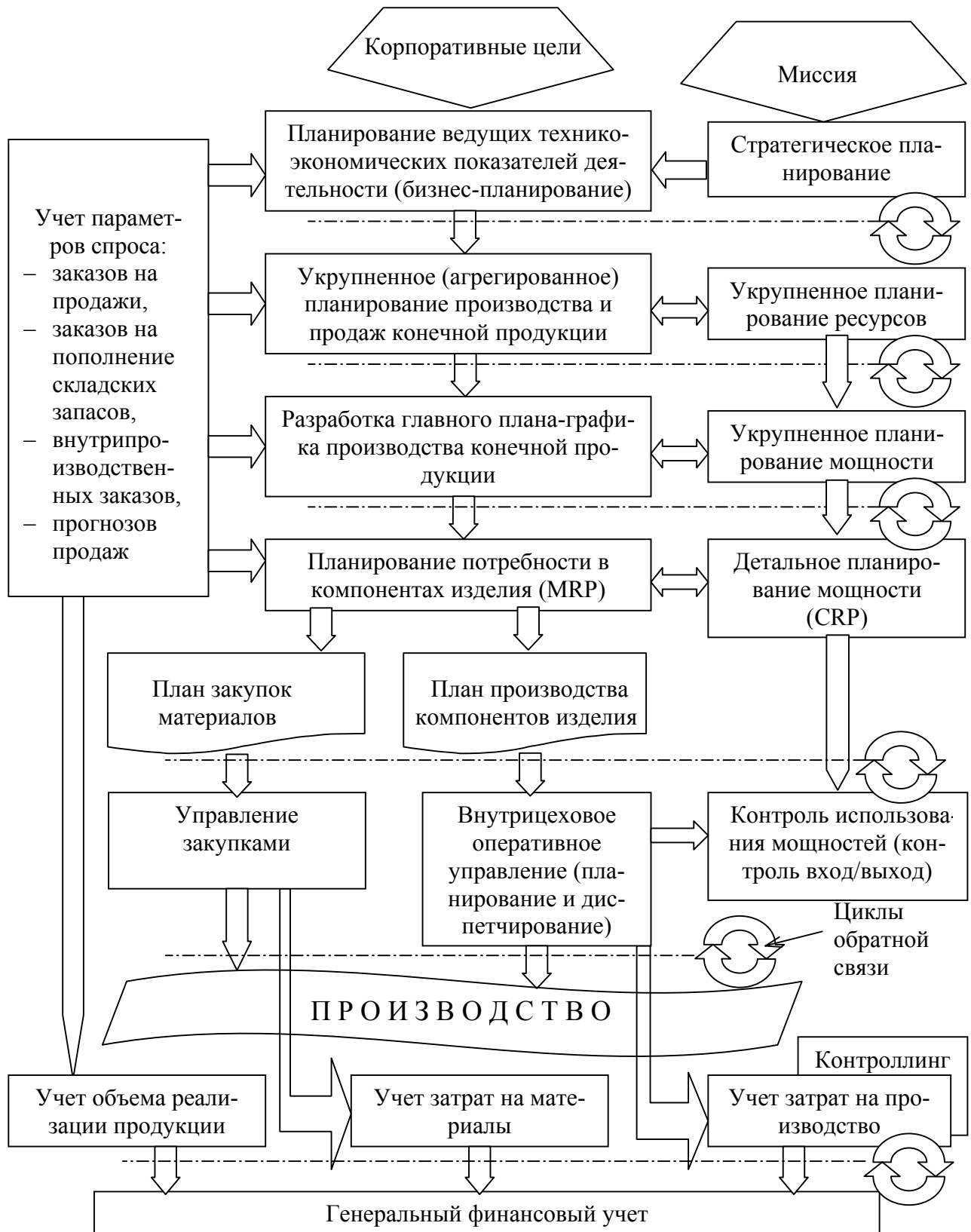
Рис. 7. Принципиальная структура комплексной системы планирования и оперативного управления производством
