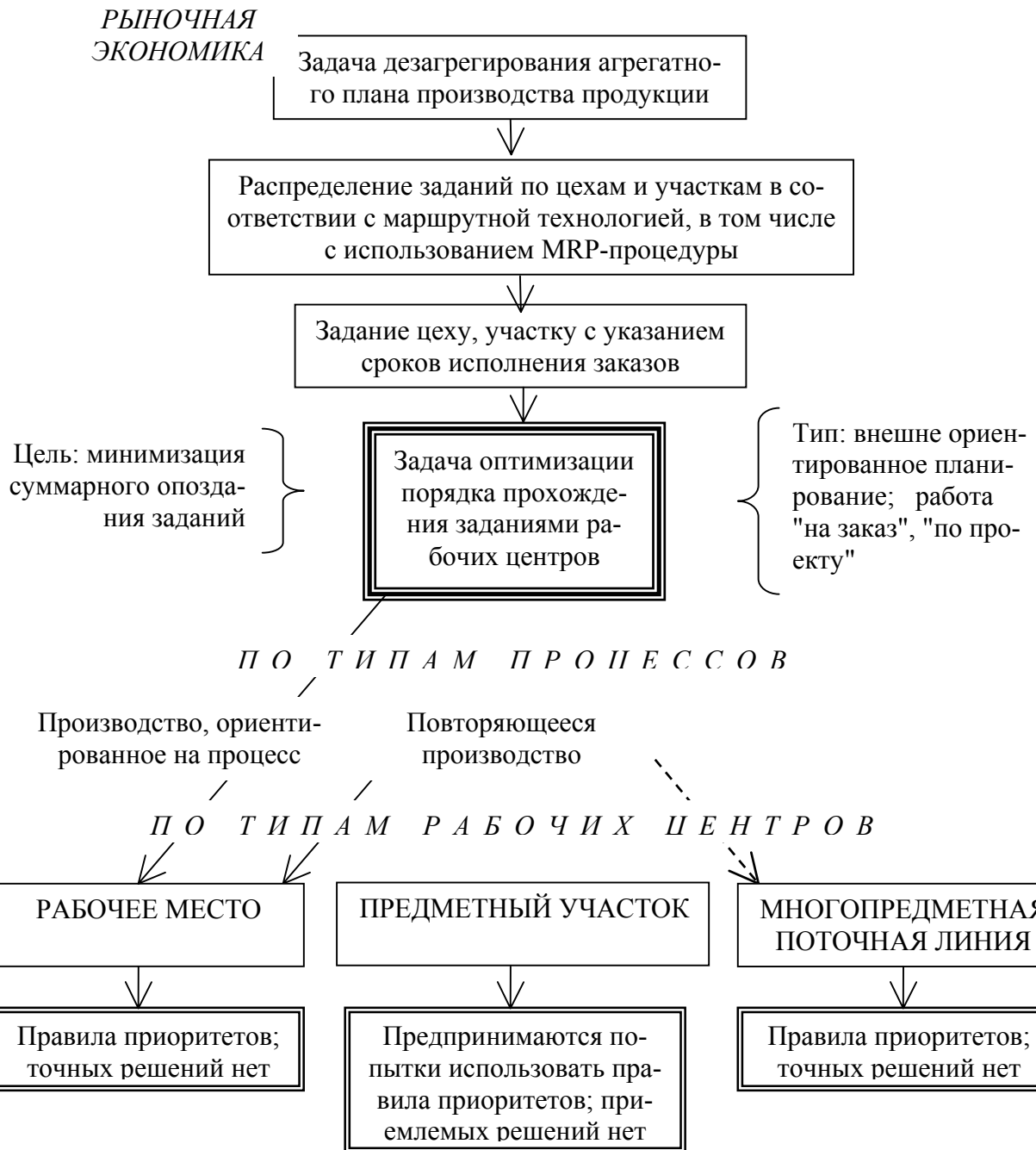
Рис. 12. Логика возникновения ситуаций, требующих минимизации суммарного опоздания заданий в рабочем центре, и методы оперативно-календарного планирования в этих ситуациях а также выработке соответствующих методов управления.
