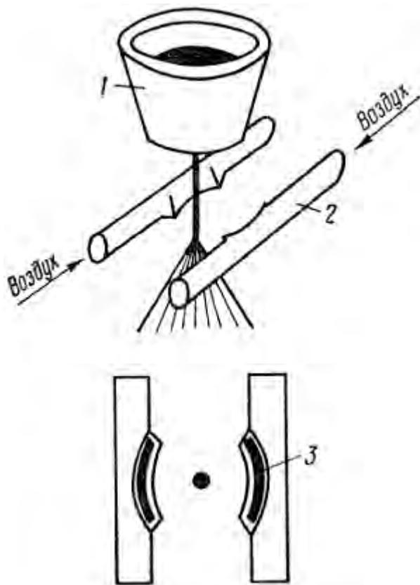
Рис. 1.36. Бесконтактная форсунка с дуговыми соплами:
