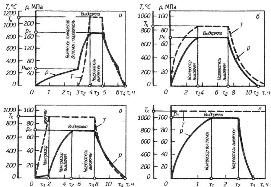
Рис. 5.7. Циклограммы ГИП:  $p$  – давление;  $T$  – температура;  $p_{\text{нач}}$  – начальное давление;  $p_k$  – конечное давление;  $T_k$  – конечная температура
