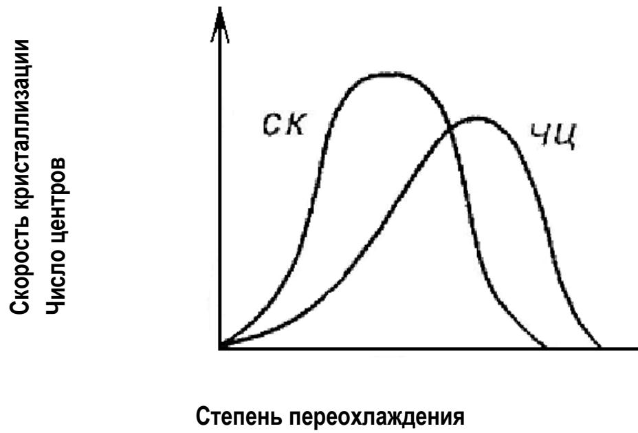
Рис. 1.19. Параметры кристаллизации в зависимости от степени переохлаждения
