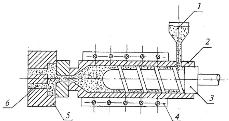
Рис. 3.30. Схема инжекционного формования: 1 – бункер с порошком; 2 – контейнер; 3 – шнек; 4 – нагреватель; 5 – форма; 6 – отформованная заготовка
