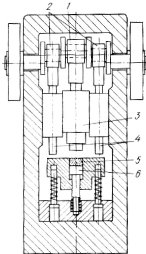
Рис. 3.25. Схема кривошипного пресса: 1 – главный кривошип; 2 – вспомогательный кривошип; 3 – прессовая головка; 4 – отжимные пуансоны; 5 – матрица; 6 - нижний пуансон
