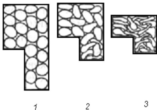
Рис. 3.12. Последовательные стадии прессования (1-3) порошков пластичных металлов
