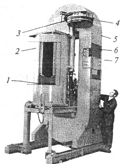
Рис. 5.6. Газостат для горячего изостатического прессования:
