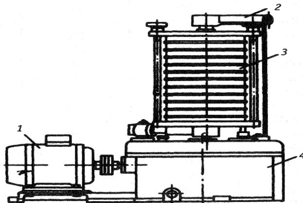
Рис. 2.3. Устройство для рассева порошков на фракции (ситовой анализатор): 1 – электродвигатель; 2 – кулиса; 3 – набор сит; 4 – корпус
