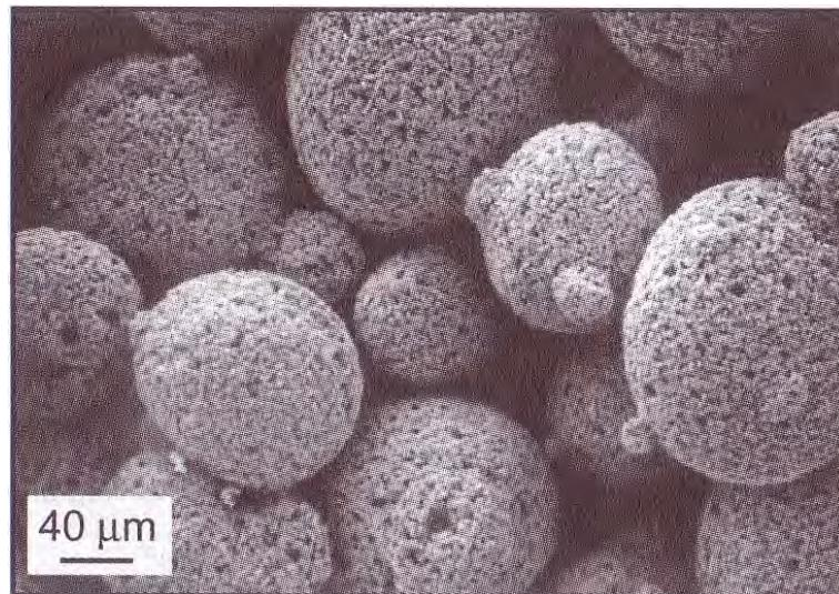
Рис. 3.10. Агломерированные частицы твердого сплава (WC+Co)
