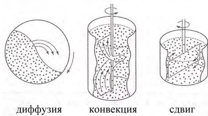
Рис. 3.6. Механизмы смещивания порошка
