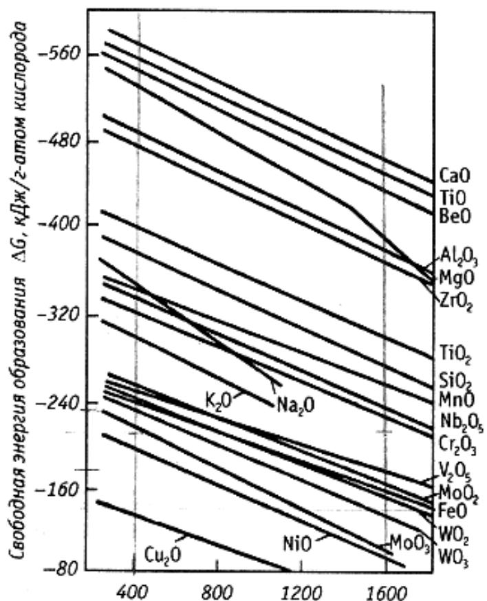
Рис. 1.11. Свободная энергия образования оксидов
