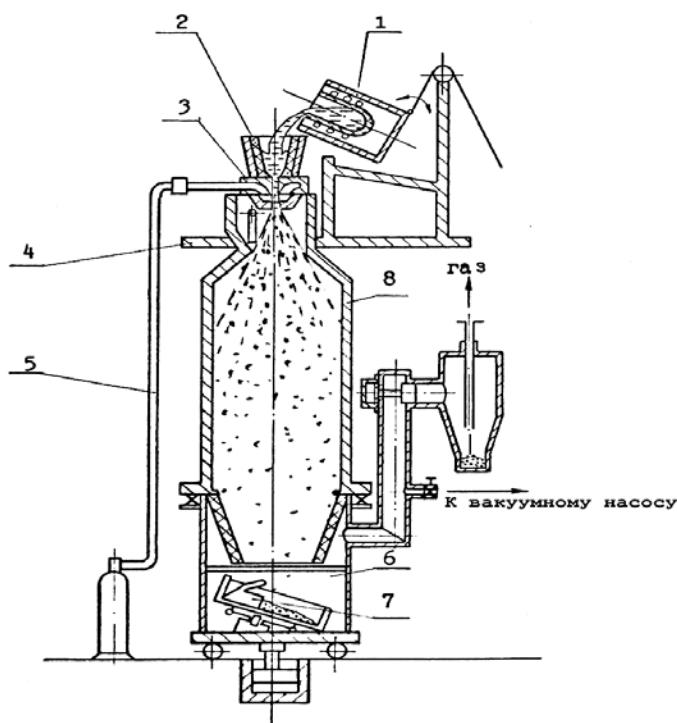
Рис. 1.31. Установка газового распыления: 1 – индукционная печь; 2 – литьяя воронка; 3 – форсунка; 4 – рабочая площадка; 5 – газопровод; 6 – сборник порошка; 7 – устройство перемешивания; 8 – камера распыления
