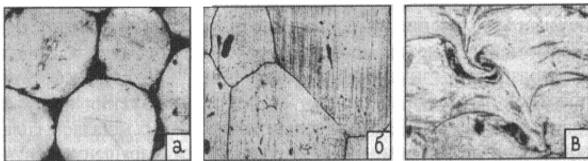
Рис. 3.34. Микроструктура брикетов из сферического медного порошка ( $-300 +160$  мкм): а – статическое формование; б – взрывное формование, скорость детонации 3500 м/с; в – взрывное формование, скорость детонации 7000 м/с
