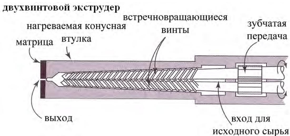
Рис. 3.7. Смеситель-экструдер: 1 - матрица; 2 - обогреваемый корпус; 3 - шнеки с противоположным вращением; 4 - привод; 5 - ввод порошка и добавок; 6 - выход смеси
