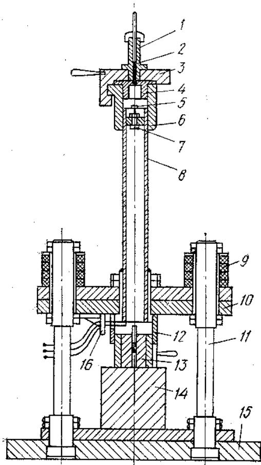
Рис. 3.31. Схема пороховой установки: 1 –ударный механизм; 2 – боек; 3 – затвор; 4 – втулка с пороховым зарядом; 5 – шпилька; 6 – неподвижная часть затвора; 7 - снаряд; 8 – ствол; 9 – амортизаторы; 10 – верхние плиты; 11 – колонки; 12 – центрующая втулка; 13 – пресс-форма; 14 – подставка; 15 – опорные плиты; 16 – контакты
