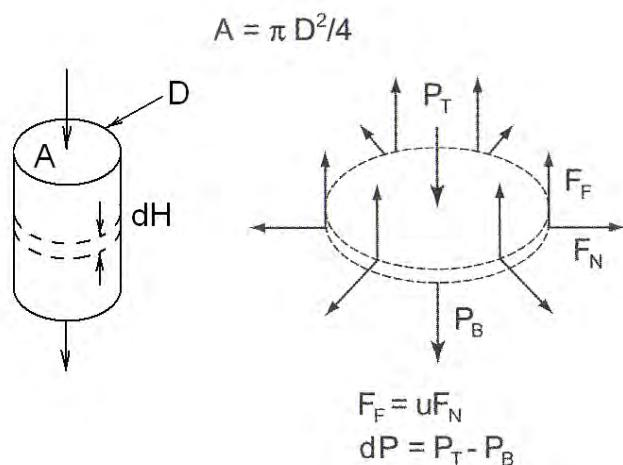
Рис. 3.18. Баланс сил при прессовании
