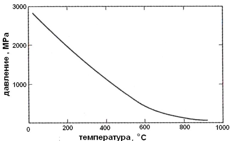
Рис. 5.2. Температура и давление, обеспечивающие плотность 99 % при горячем прессовании железного порошка
