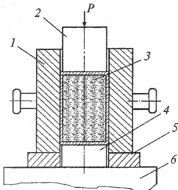
Рис. 5.4. Горячее прессование капсулы с порошком: 1 – штамп; 2 – верхний пуансон; 3 – капсула с порошком; 4 – нижний пуансон; 5 – подкладное разрезное кольцо; 6 – шабот пресса
