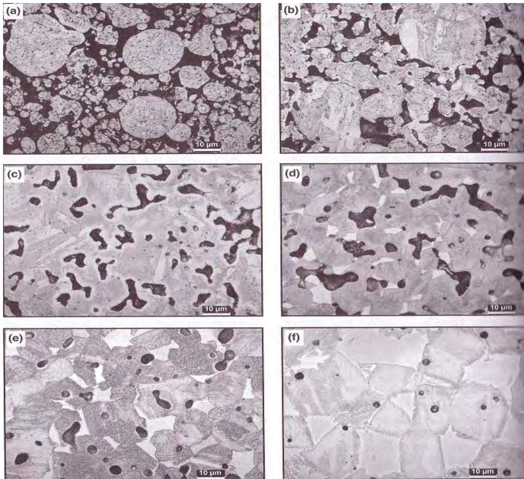
Рис. 4.12. Микроструктура формовок из порошка нержавеющей стали, спеченных при разной температуре: а – 1000°С; б – 1100°С; в – 1200°С; г – 1260°С; д – 1300 °С; е – 1365°С
