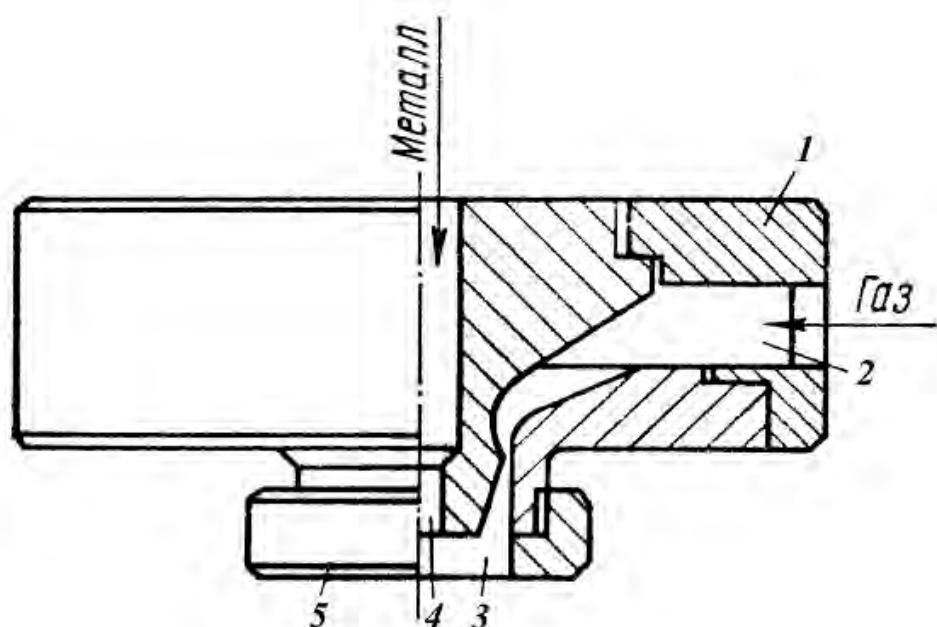
Рис. 1.33. Форсунка, работающая на горячем дутье: 1 – корпус; 2 – газовая камера; 3 – сопло Лаваля; 4 – канал для расплава; 5 – удлинитель сопла
