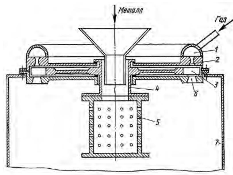
Рис. 1.43. Устройство с вращающимся перфорированным стаканом:
