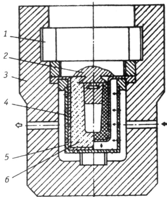
Рис. 3.27. Схема установки для ХИП по методу «сухой мешок»:
