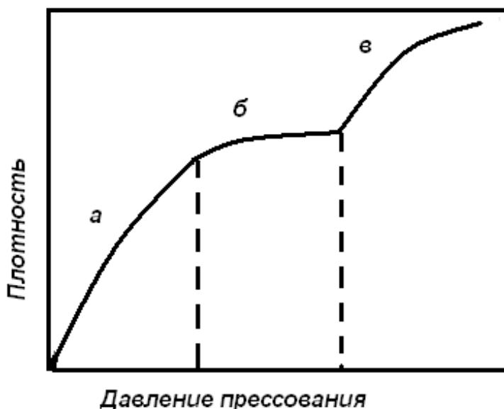
Рис. 3.13. Идеализированная кривая процесса уплотнения порошков пластиичных металлов
