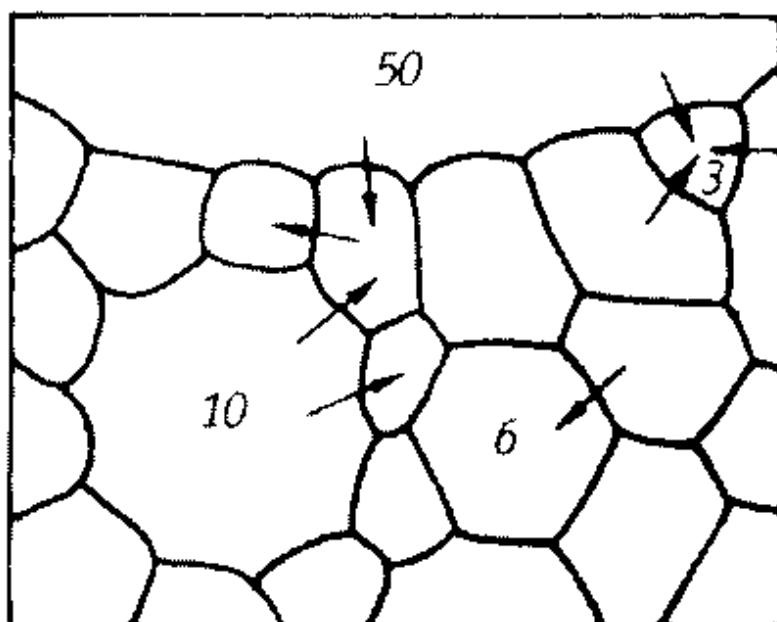
Рис. 4.7. Схема роста частиц при нагреве порошкового тела
