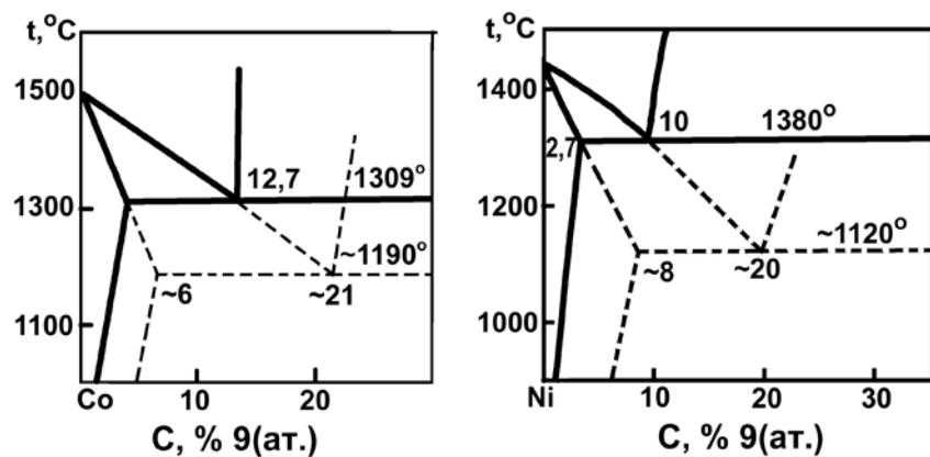
Рис. 1.14. Диаграммы состояния сплавов Со-С(а) и Ni-С (б):
