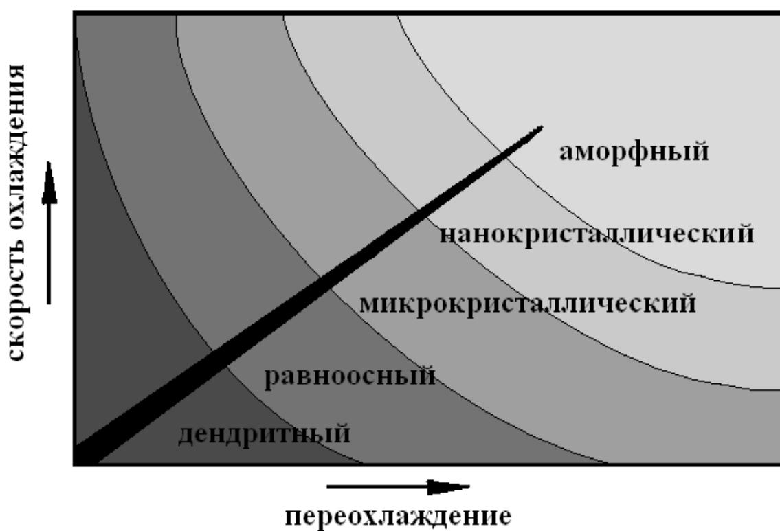
Рис. 1.22. Трансформация структур
