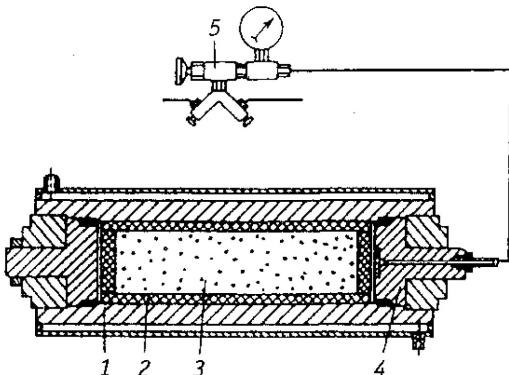
Рис. 1.17. Схема СВС - реактора: 1 – корпус; 2 – графитовая футеровка; 3 – реакционная шихта; 4 – грибковый затвор; 5 – газораспределительный узел
