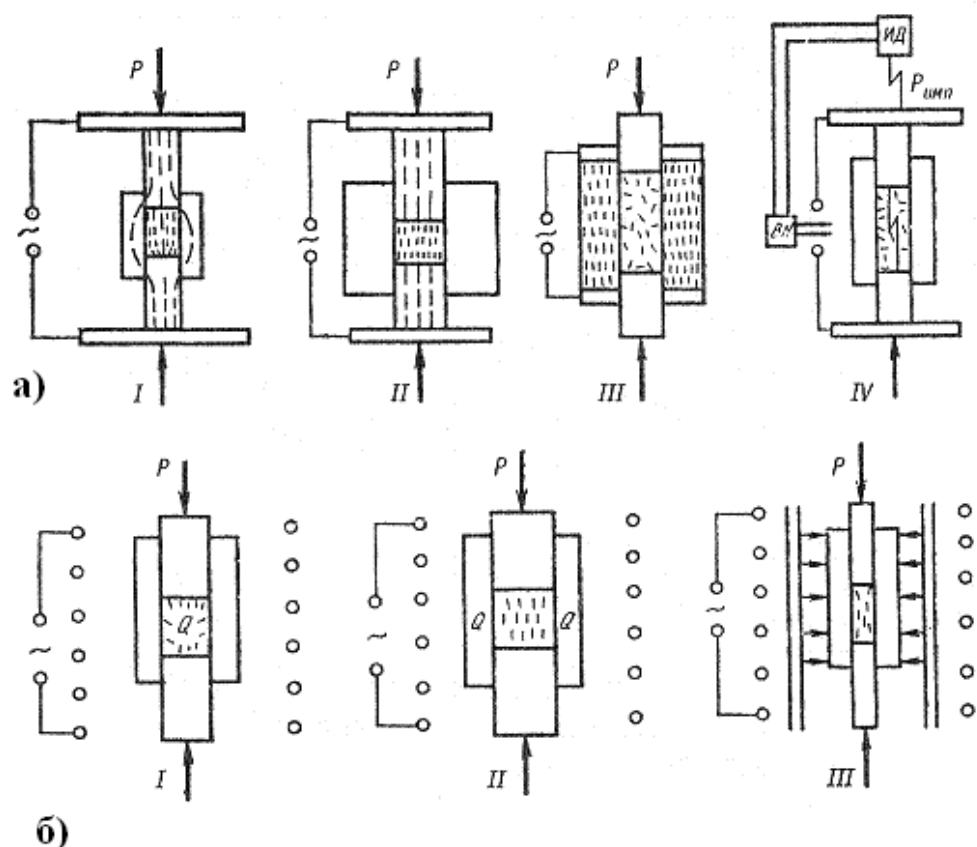
Рис. 5.3. Способы нагрева порошка при горячем прессовании:
