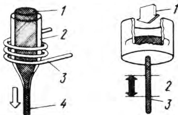
Рис. 1.46. Схемы устройств для получения тонких нитей:
