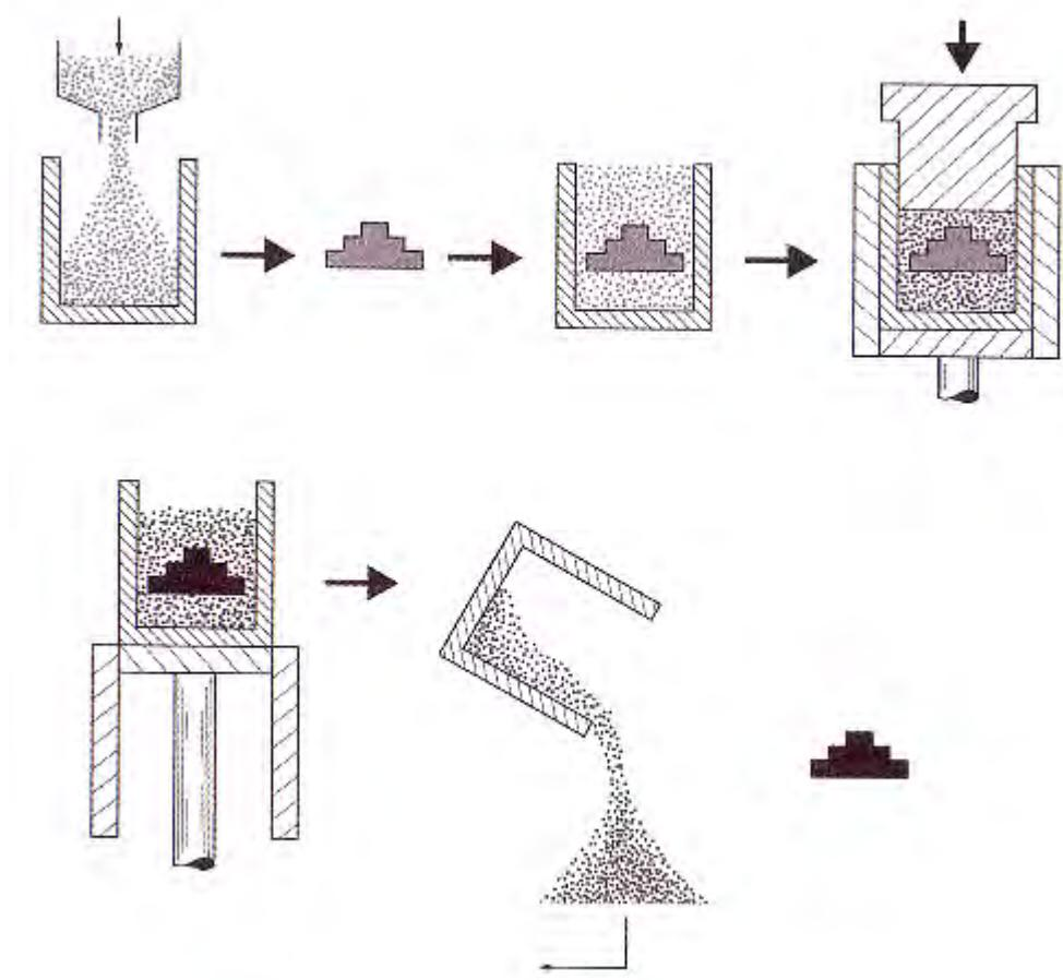
Рис. 5.8. Схема псевдо-ГИП
