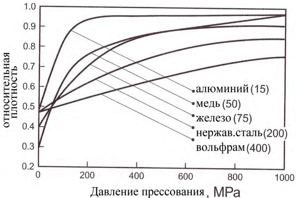
Рис. 3.15. Относительная плотность прессовок из порошков разных металлов в зависимости от давления прессования:
