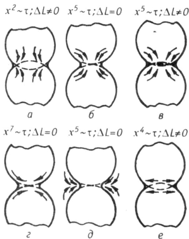
Рис. 4.3. Схема разных механизмов припекания сферических частиц:
