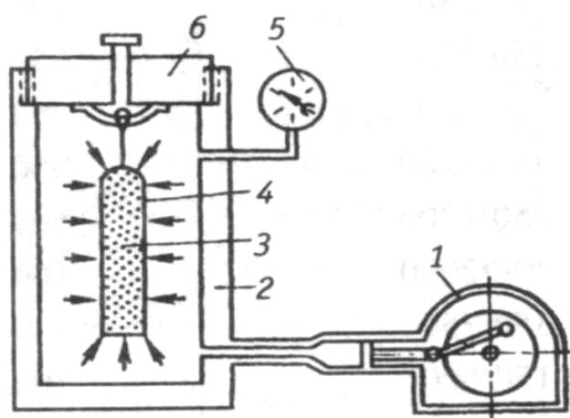
Рис. 3.26. Схема установки для ХИП по методу «мокрый мешок»:
