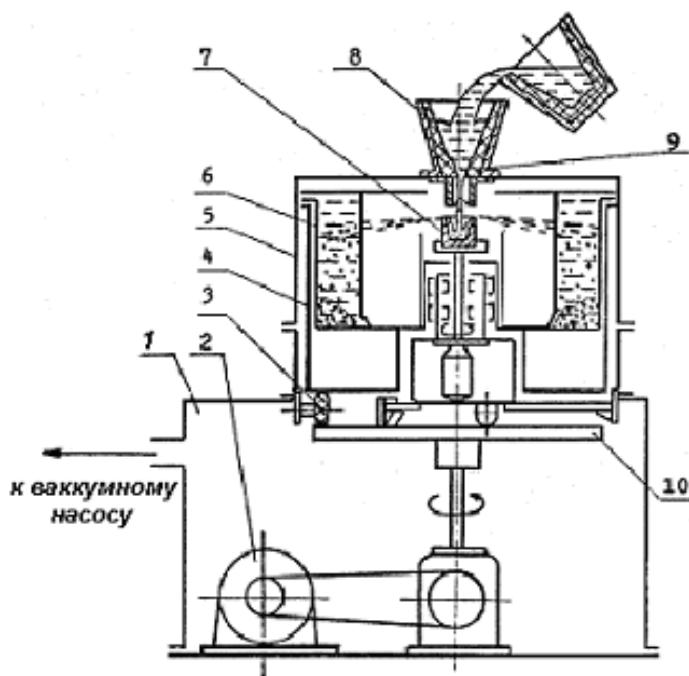
Рис. 1.44. Опытная установка центробежного распыления:
