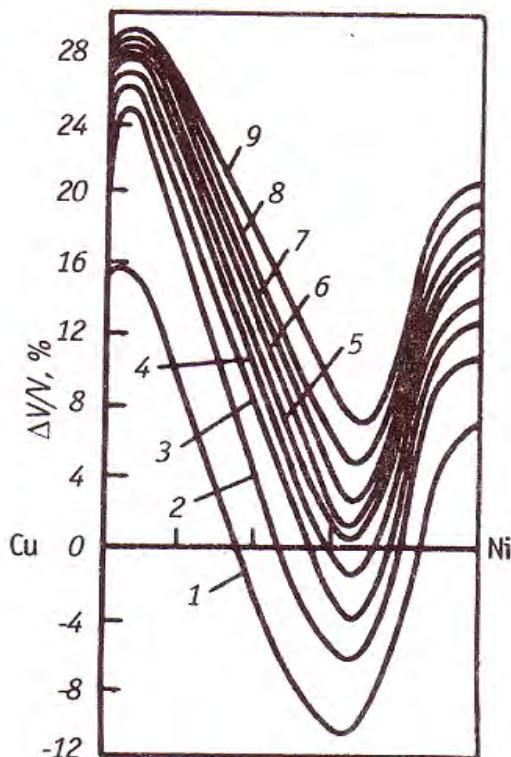
Рис. 4.13. Концентрационная зависимость усадки в системе Cu-Ni после спекания при 1000°С и выдержках: 1 – 0; 2 – 2; 3 – 5; 4 – 10; 5 – 15; 6 – 20; 7 – 30; 8 – 60; 9 – 120 мин
