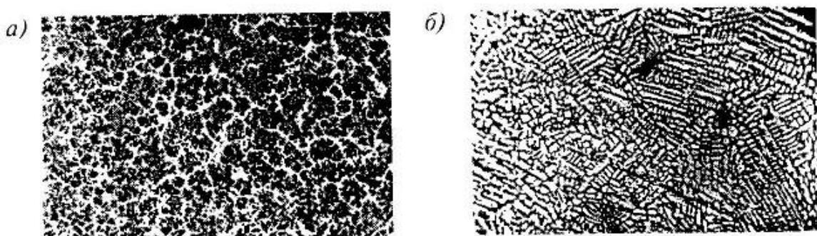
Рис. 1.28. Микроструктура порошка быстрорежущей стали, x250:
