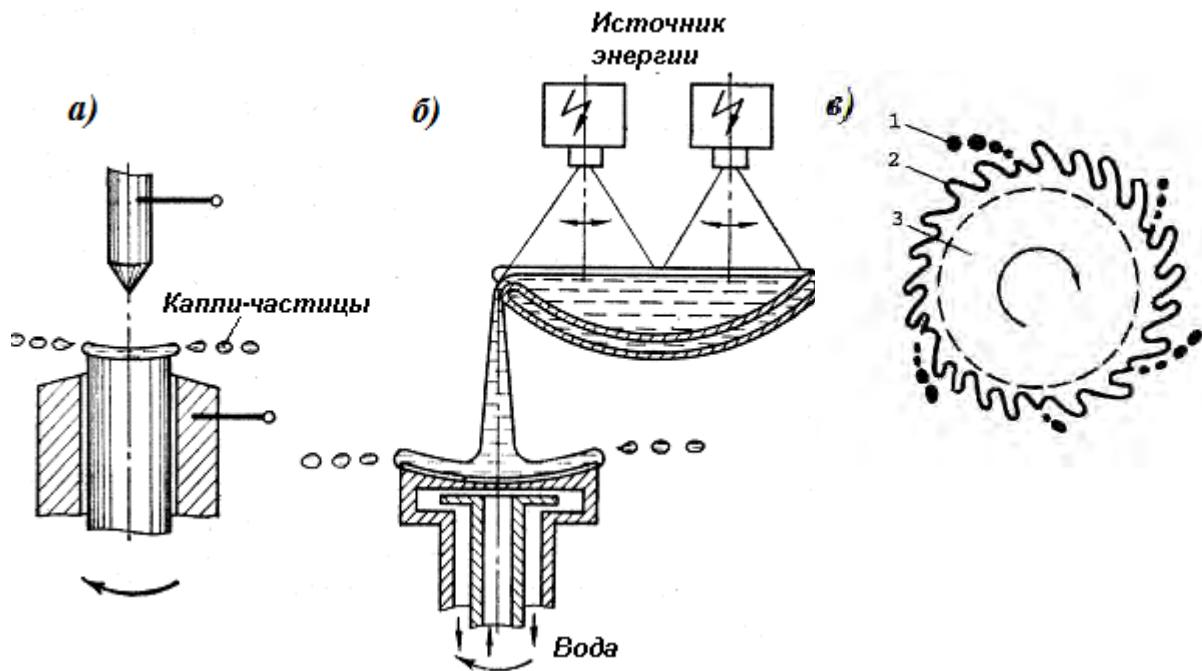
Рис. 1.40. Центробежное распыление расплава: а – метод вращающегося электрода; б – метод заливки на вращающийся распылитель; в – формирование капель (1 – частицы; 2 – торOIDальный валик; 3 – вращающийся распылитель
