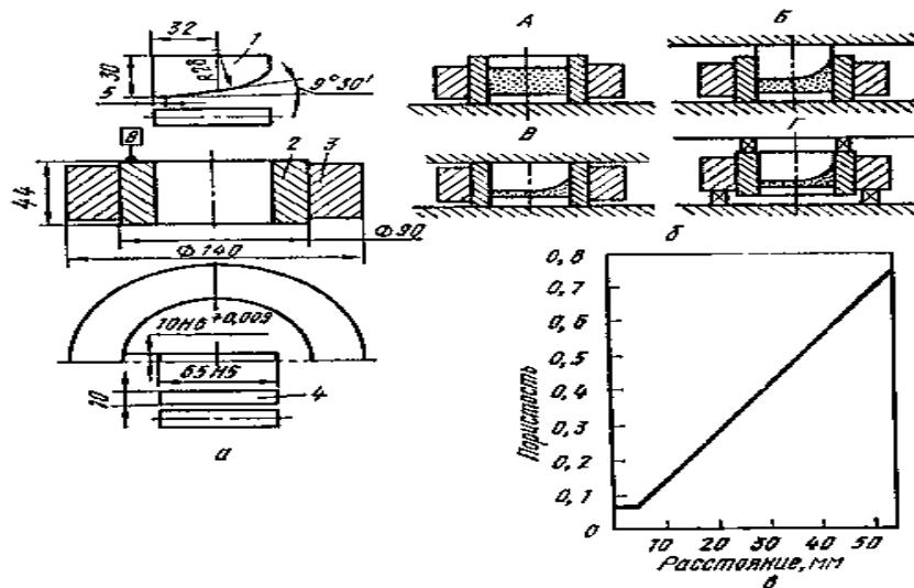
Рис. 2.18. Приспособление для определения формуемости порошка (а), схема получения образцов (б) и диаграмма для нахождения значений пористости (в): 1 – пuhanсон верхний; 2 – матрица; 3 – обойма; 4 – пuhanсон нижний; А – заполнение порошком; Б, В – прессование порошка; Г – выталкивание образца
