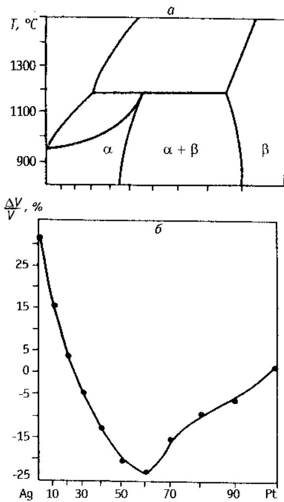
Рис. 4.15. Диаграмма состояния (а) и концентрационная зависимость усадки (б) порошковых тел системы Ag-Pt при 700°C
