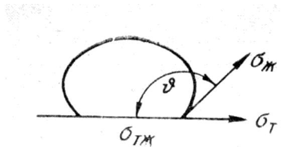
Рис. 4.17. Равновесие жидкой капли на твердой поверхности
