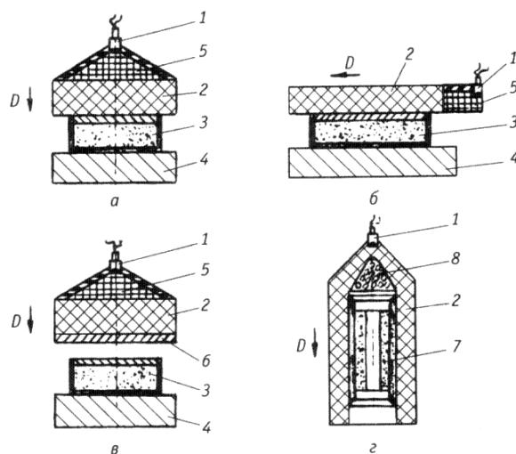
Рис. 3.33. Типовые схемы формования порошков зарядом бризантных ВВ:
