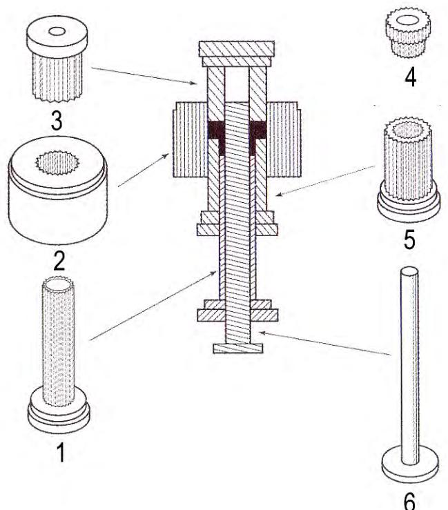
Рис. 3.24. Пресс-форма детали «шестерня»: 1 – верхний пuhanсон; 2 – матрица; 3 – внутренняя втулка нижнего пuhanсона; 4 – стержень; 5 – наружная втулка нижнего пuhanсона, 6 – прессовка
