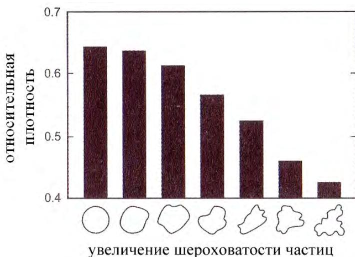
Рис. 3.4. Влияние формы частиц на плотность упаковки порошка
