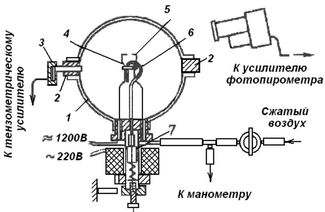
Рис. 2.1. Установка для исследования воспламеняемости аэрозолей металлов
