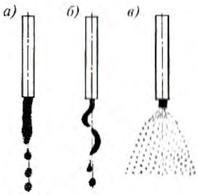
Рис. 1.18. Схема распада струй в зависимости от скорости их истечения ( $W$ ):
