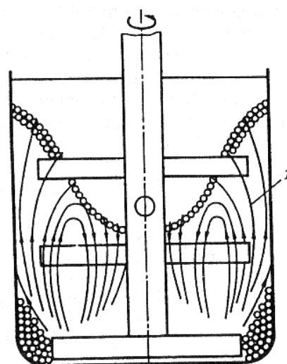
Рис. 1.8. Схема движения шаров в аттриторе
