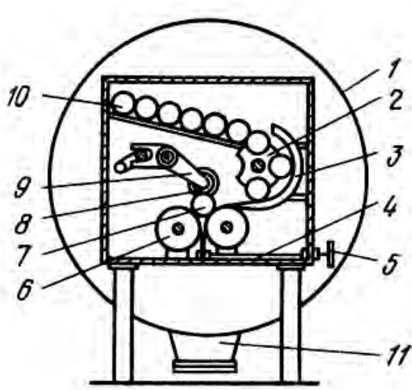
Рис. 1.42. Схема установки ВГУ-2: 1 – корпус; 2 – механизм подачи заготовок; 3 – станина; 5 – регулятор зазора; 6 – опорные валки; 7 – вращающаяся распыляемая заготовка; 8 – ведущий ролик; 9 – толкатель; 10 – магазин заготовок; 11 – бункер для выгрузки порошка
