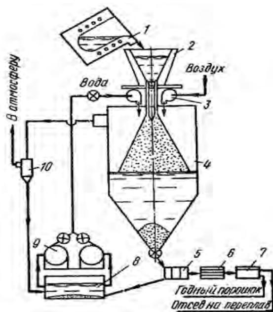
Рис. 1.37. Схема установки распыления расплава водой:
