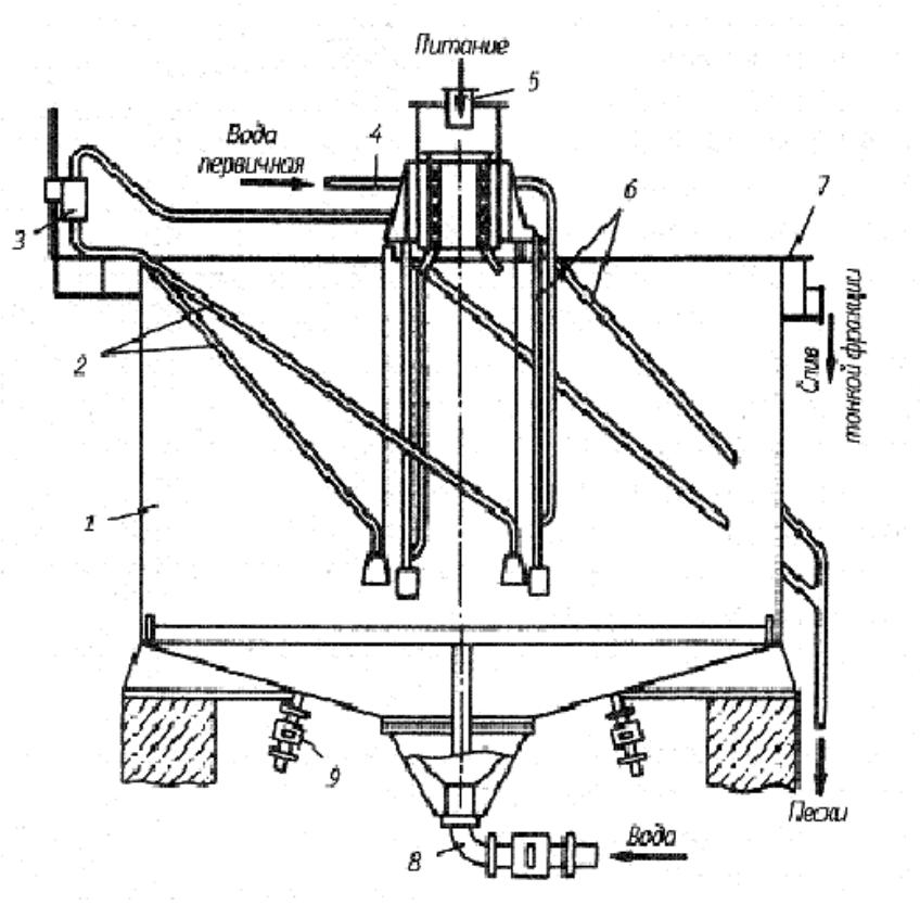
Рис. 3.2. Схема гидравлического классификатора: 1 – чан; 2 – пьезометрические трубы; 3 – клапан; 4,8 – трубы для подачи воды; 5 – патрубок; 6 – сифоны; 7 – желоб; 9 – штуцеры
