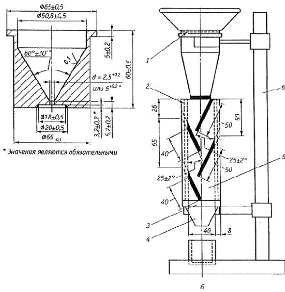
Рис. 2.14. Приборы для определения насыпной плотности порошка:
