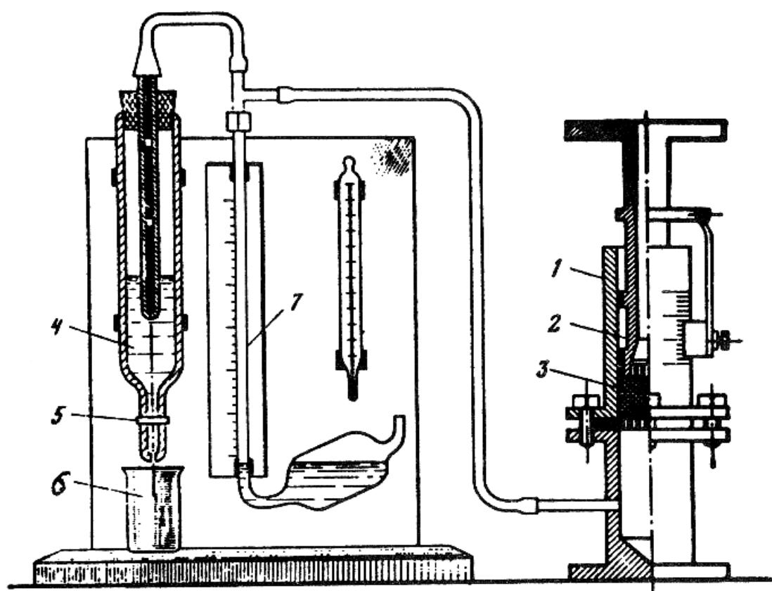
Рис. 2.9. Схема прибора Товарова: 1 – гильза; 2 – плунжер; 3 – проба порошка; 4 – склянка Мариотта; 5 – кран; 6 – стакан; 7 – манометр
