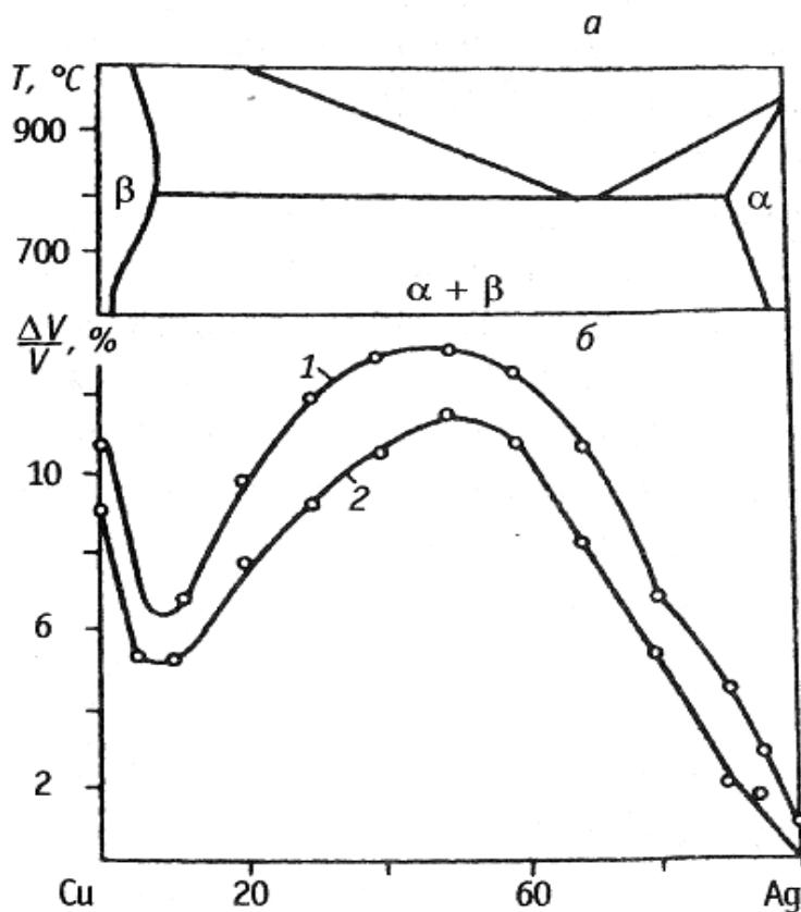
Рис. 4.14. Диаграмма состояния (а) и концентрационная зависимость усадки (б) порошковых тел системы Cu-Ag при 700 °С и выдержке 30 (1) и 15 мин (2)
