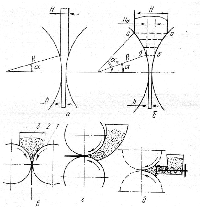
Рис. 3.37. Схемы прокатки: а – литого металла; б – порошка; в – вертикальная; г – горизонтальная с гравитационной подачей порошка; д – горизонтальная с принудительной подачей порошка. 1 – валки; 2 – бункер для порошка; 3 – порошок; R – радиус валка;  $\alpha$  – угол прокатки;  $\alpha_h$  – угол подачи порошка; h – толщина проката
