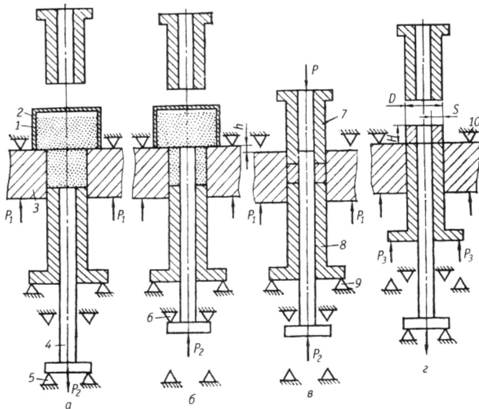
Рис. 3.23. Кинематическая схема прессования гладких втулок:
