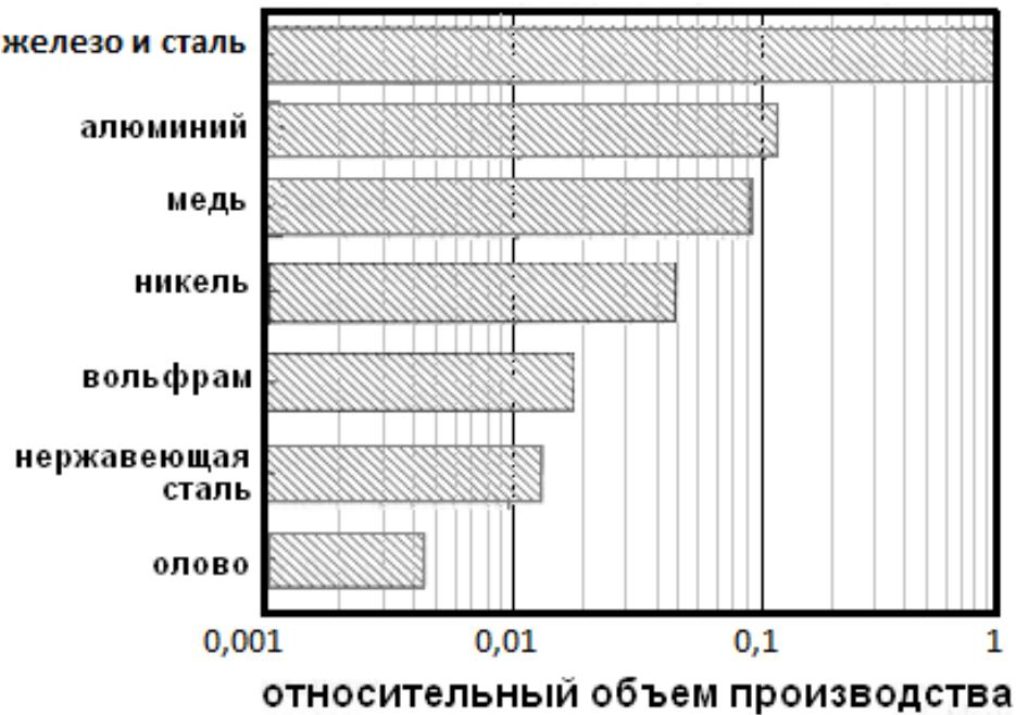
Рис. 1.1. Относительный объем производства металлических порошков
