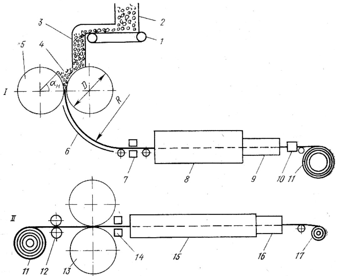
Рис. 3.38. Схемы производства полосы из порошка:
