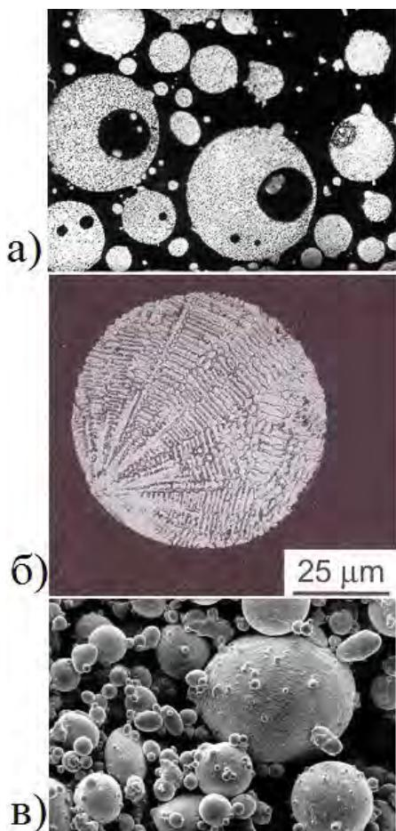
Рис. 1.29. Дефекты порошковых частиц,  $\times 250$ : а – газовые раковины; б - крупный дендрит; в – сателлиты
