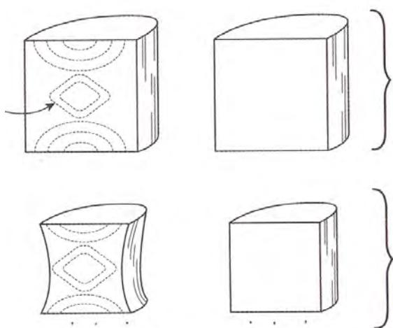
Рис. 4.11. Усадка при спекании у разных формовок
