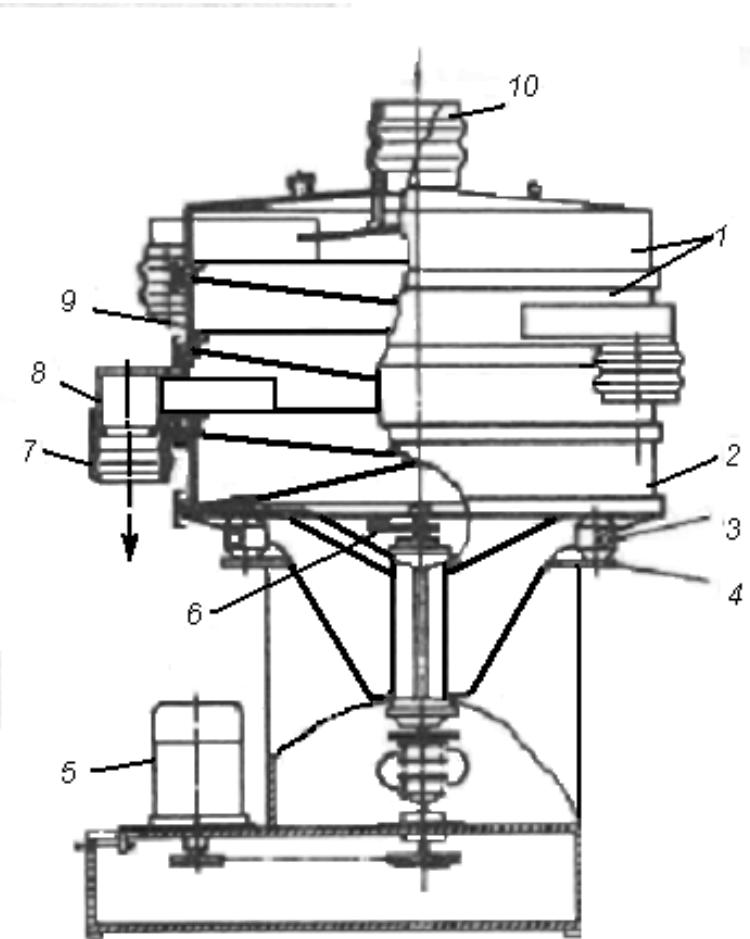
Рис. 3.1. Вибросито СВ3 0,9: 1 – цилиндрическая обечайка; 2 – нижняя обечайка; 3 – упругие связи; 4 – рама; 5 – двигатель; 6 – вал вибровозбудителя; 7 – манжеты, 8 - разгрузочный патрубок; 9 – рассеивающие поверхности; 10 – загрузочный патрубок
