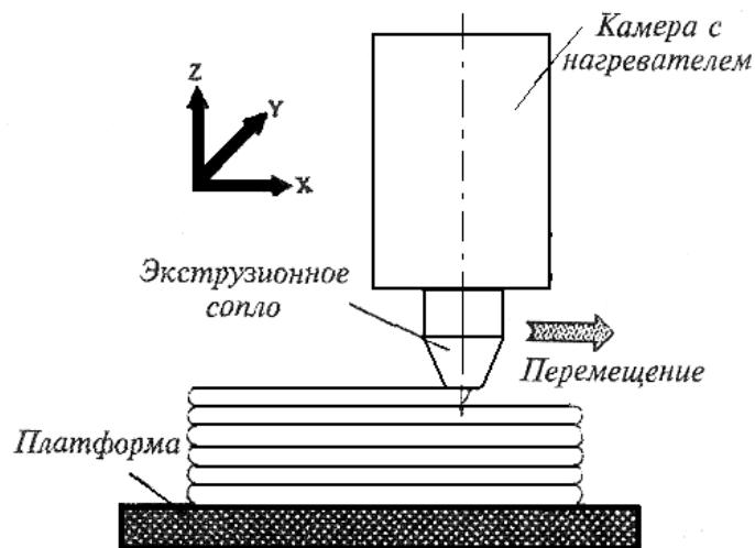
Рис. 6.1. Схема мультифазного струйного затвердевания (MJS-процесс)
