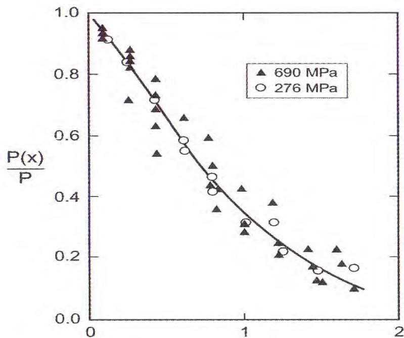
Рис. 3.19. Трансформированное давление в прессовке медного порошка на разных уровнях высоты
