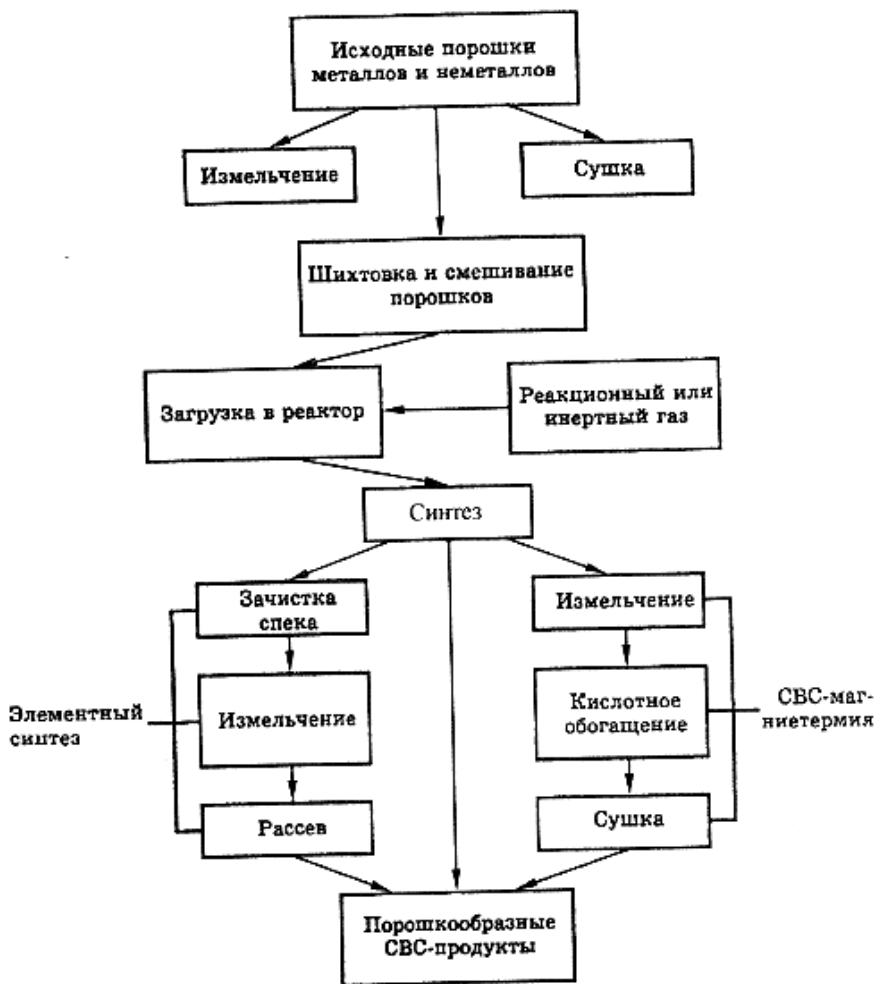
Рис. 1.16. Схема СВС – технологии получения порошка
