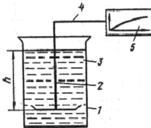
Рис. 2.4. Схема устройства для седиментационного анализа: 1 – стеклянная кювета; 2 – стержень с чашкой весов; 3 – дисперсионная
