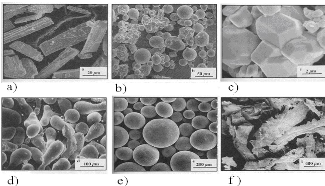
Рис. 2.2. Микрофотографии металлических порошков, полученных различными способами:
