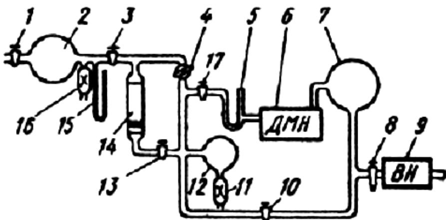
Рис. 2.10. Схема прибора Дерягина: 1, 3, 4, 8, 11, 13, 17 – краны; 2, 7, 12 – баллоны; 5 – вымораживающая ловушка; 6, 9 – вакуумные насосы;
