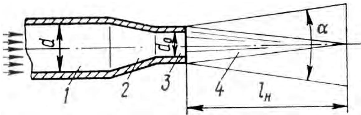
Рис. 1.39. Схема сопловой насадки гидравлической форсунки:
