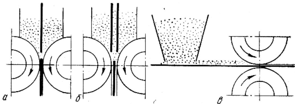
Рис. 3.39. Схемы прокатки слоистых полос:
