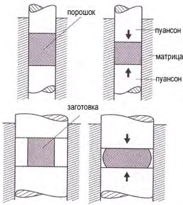
Рис. 5.10. Положение заготовки при прессовании и штамповке
