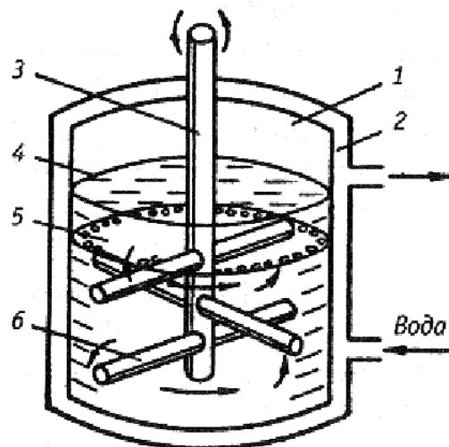
Рис. 1.7. Схема вертикального аттритора: 1 – корпус; 2 – рубашка водяного охлаждения; 3 – вал мешалки; 4 – измельчаемый материал; 5 – размольные шары; 6 – лопасти мешалки
