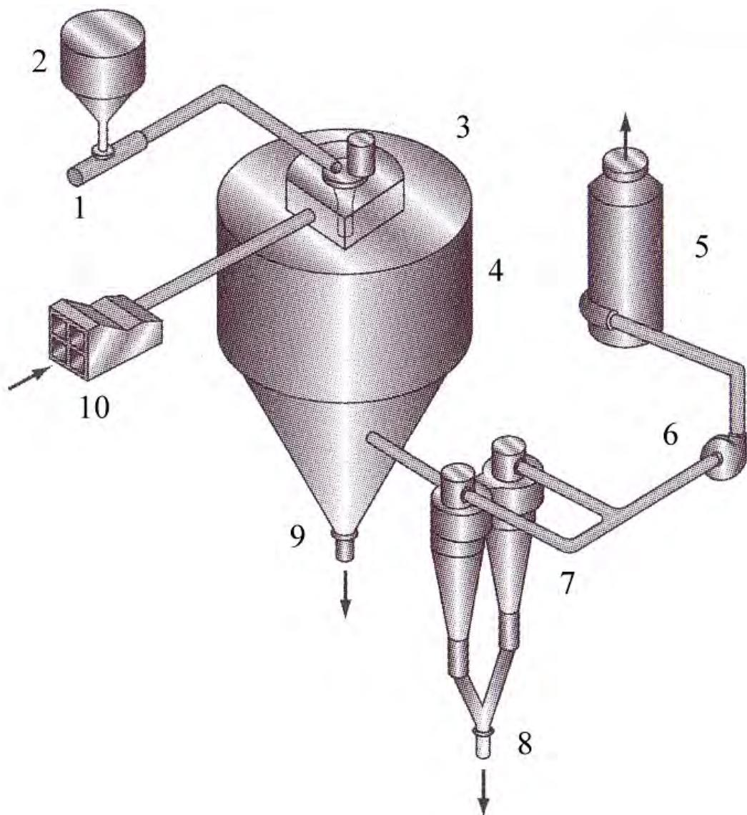
Рис. 3.9. Схема распылительной системы для грануляции дисперсных порошков:
