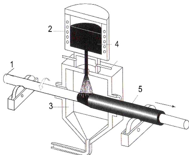
Рис. 6.5. Схема производства трубной заготовки
