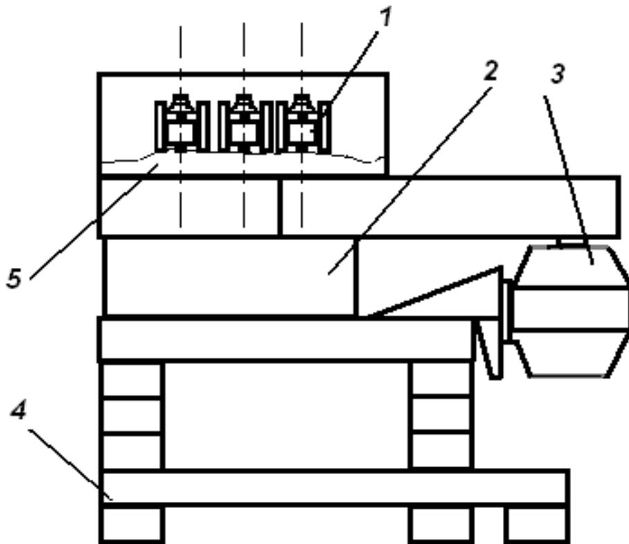
Рис. 1.5. Планетарная центробежная мельница: 1 – корпус – шкив с обоймами; 2 – основание; 3 – электродвигатель; 4 – кожух; 5 – подставка
