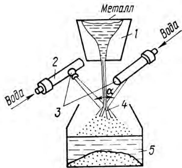
Рис. 1.38. Схема распыления расплава двухкамерной форсункой:
