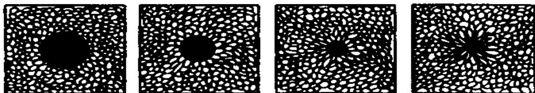
Рис. 4.5. Залечивание поры в режиме вязкого течения
