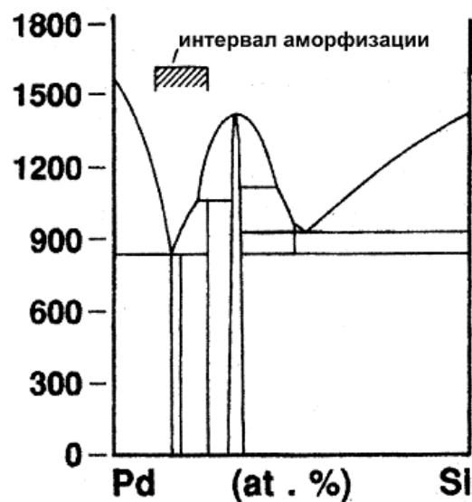
Рис. 1.26. Область аморфных составов в системе Pd-Si
