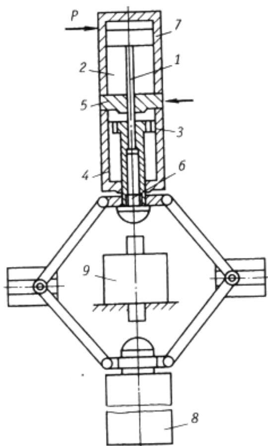
Рис 3.36. Схема установки для пневмомеханического формования порошков
