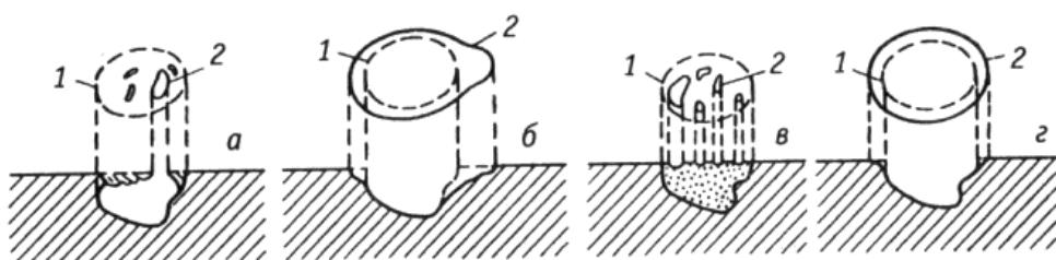
Рис. 7.2. Схема одновременного калибрования наружной и внутренней поверхности детали: а – загрузка; б – калибрование; в – выталкивание детали; г – удаление плитки
