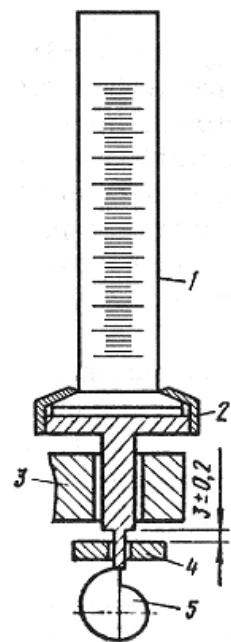
Рис. 2.15. Прибор для определения плотности утряски порошка:
