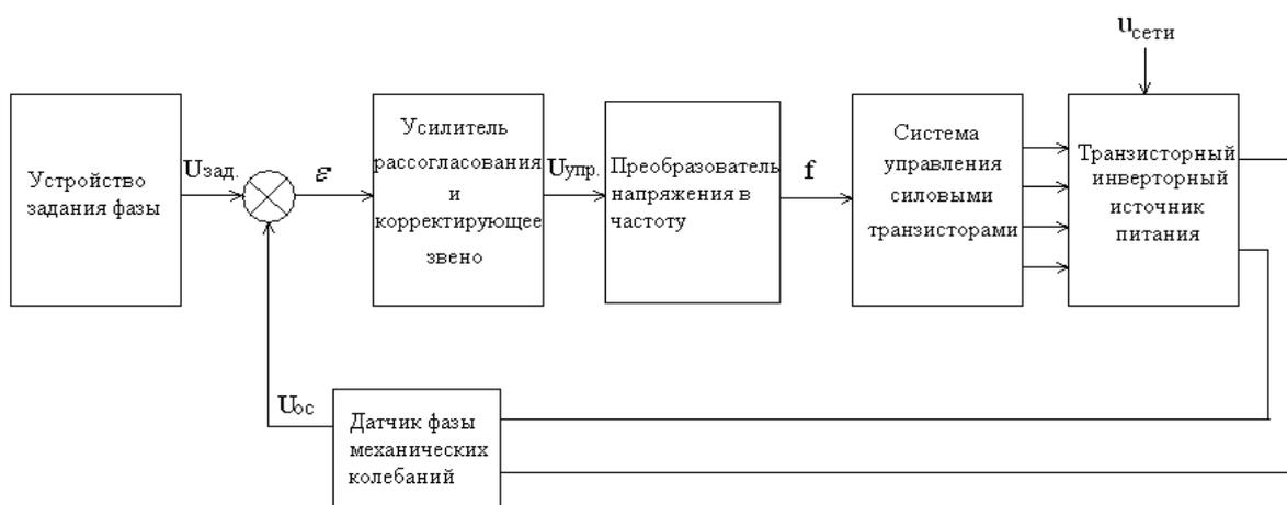
Рис. 9.5. Функциональная схема системы автоматической подстройки частоты
