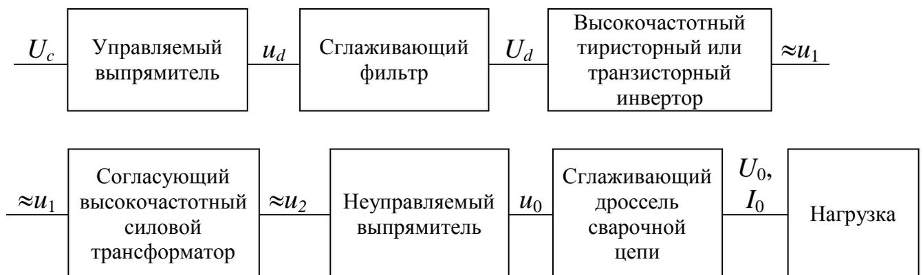
Рис. 4.1. Структурная схема источника питания
