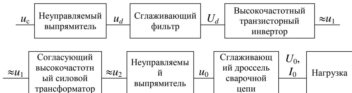
Рис. 5.1. Структурная схема транзисторного инверторного источника питания
