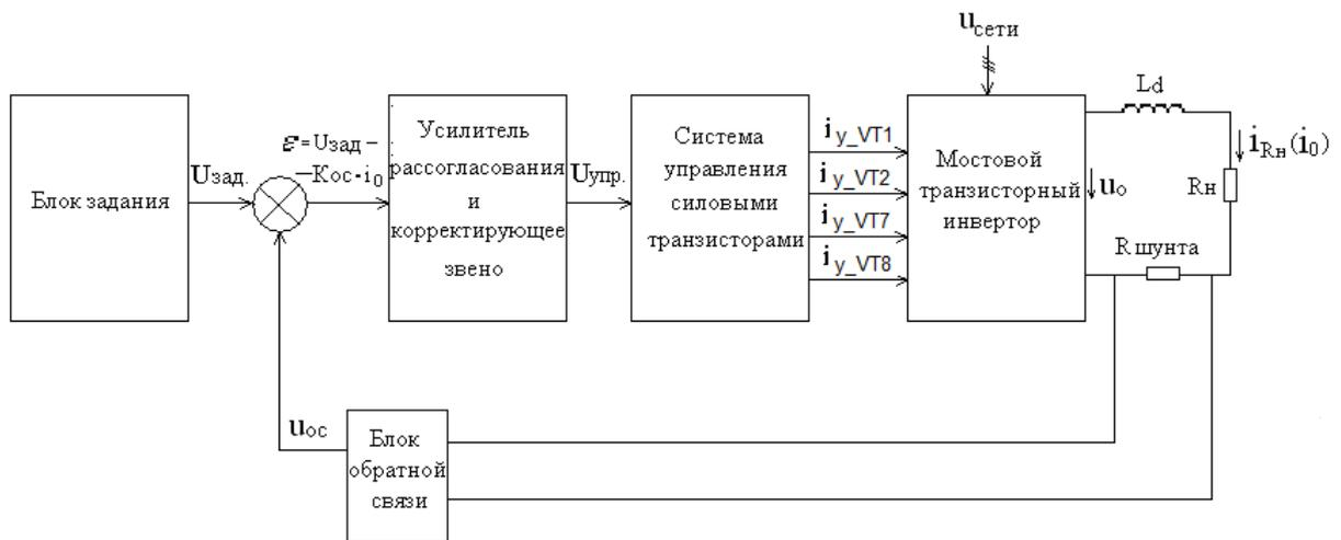
Рис. 6.2. Функциональная схема замкнутой системы стабилизации тока сварки
