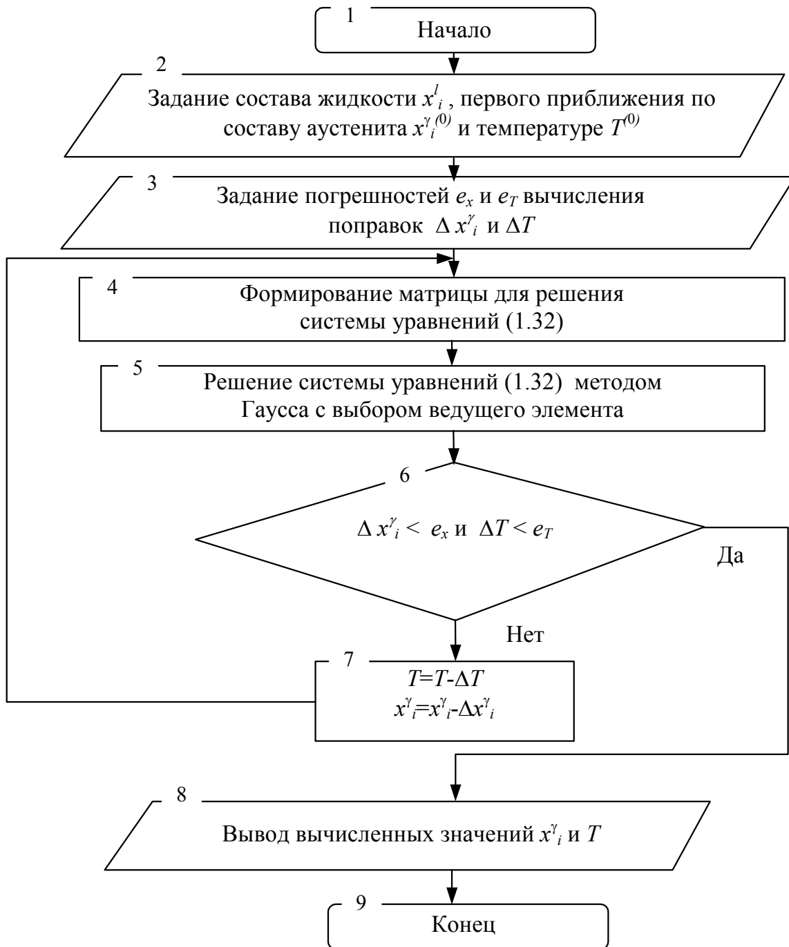
Рис. 1.1. Алгоритм расчета термодинамического равновесия жидкости и аустенита в системе Fe-C-Si-Cr
