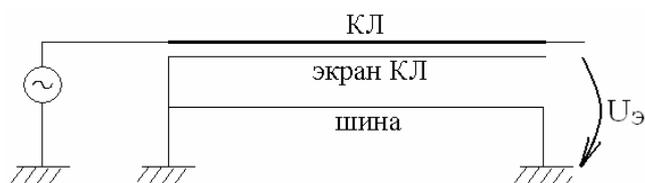
Рис. 5. Схема заземления экранов кабелей и шины
