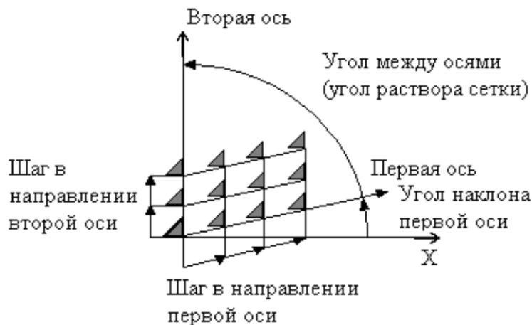
Рис. 8.2. Схема образования параллелограммной сетки
