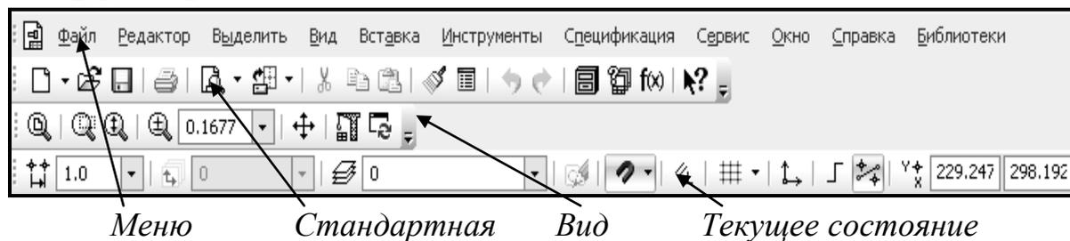
Рис. 1.1. Панели системы в режиме работы с чертежом
