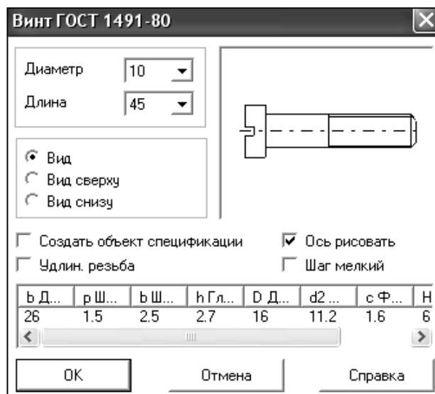
Рис. 3.1. Диалог задания параметров стандартного элемента
