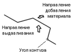
Рис. 10.8. Пример разомкнутого эскиза для построения листового тела
