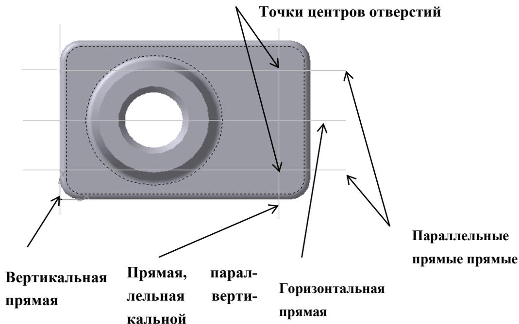
Рис. 7.13. Построение точек центров отверстий
