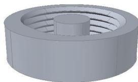
7. Вырезаем в нашей основной детали цилиндр, радиуса 17 и вставляем нашу внутреннюю резьбу(проделываем пункт 4 и копируем нажатиями клавишами shift+Ctrl+C и вставляем). Потом совмещаем две детали как в пункте 5.
