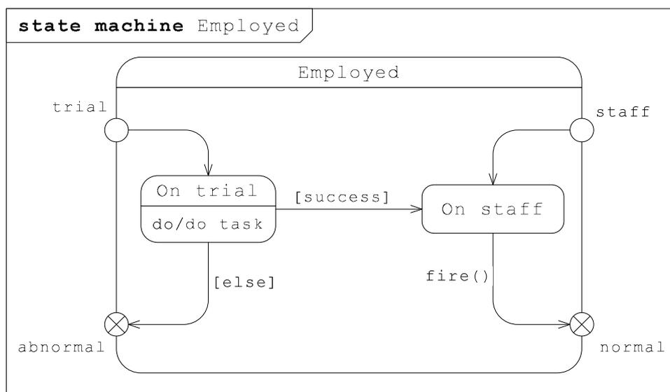
Рис. 4.12. Составное состояние, раскрывающее вложенную машину состояний
