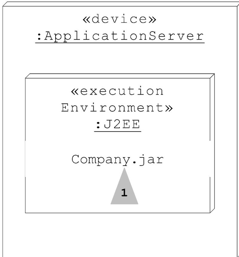
Рис. 3.20. Нотация узла
