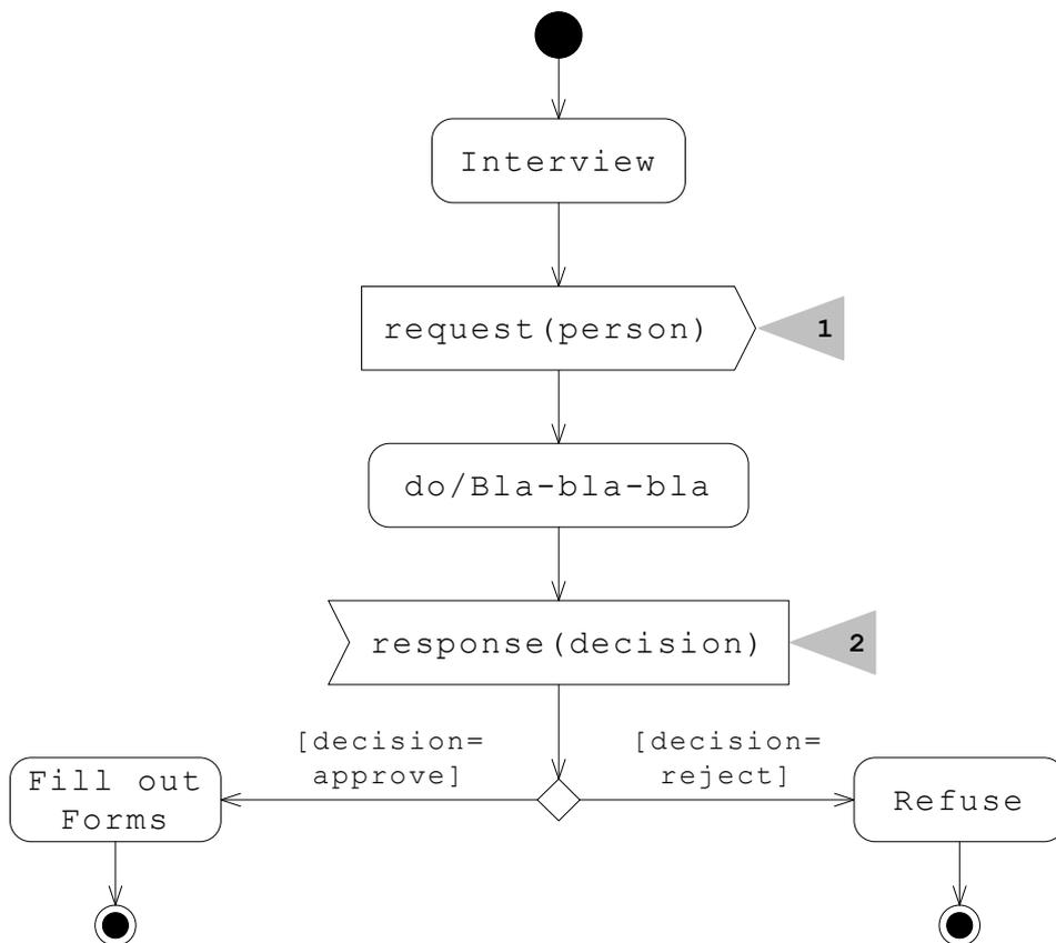
Рис. 4.27. Специальные обозначения для отправки и приема сигналов
