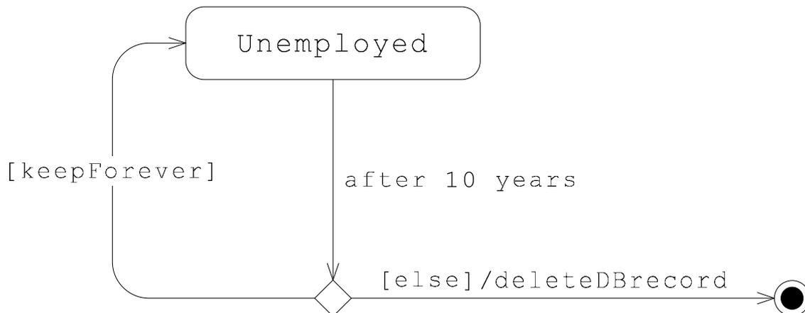
Рис. 4.15. Переход по событию таймера со сторожевым условием
