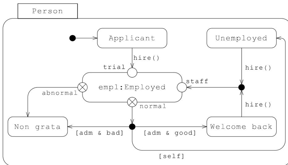
Рис. 4.11. Составное состояние, использующее вложенный конечный автомат
