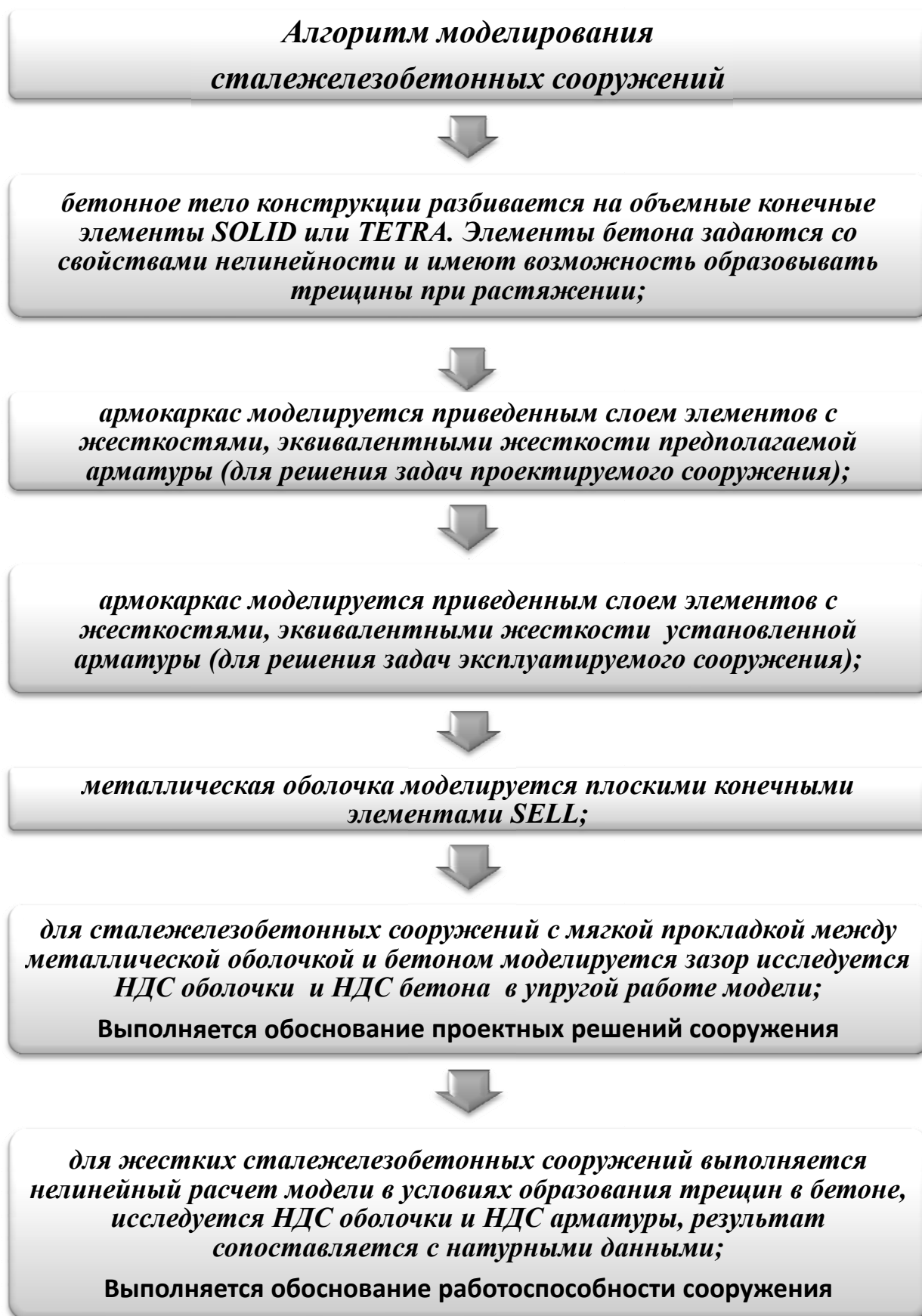
Рисунок 1. Алгоритм моделирования сталежелезобетонных сооружений
