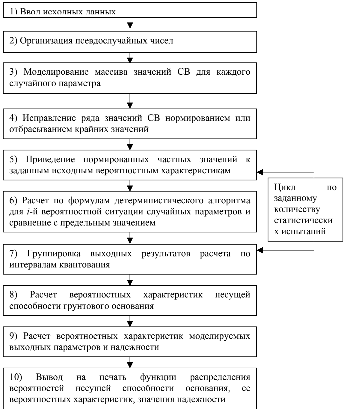
Рис.1. Укрупненная блок-схема предлагаемого улучшенного алгоритма расчета надежности грунтового основания методом Монте-Карло.
