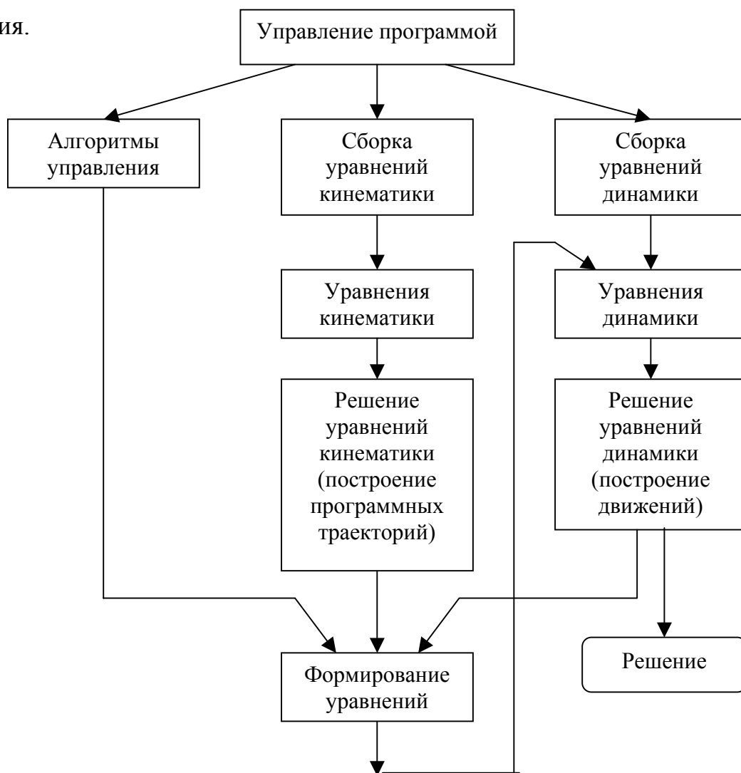
Рис. 1.16. Схема пакета программы моделирования манипуляционных систем
