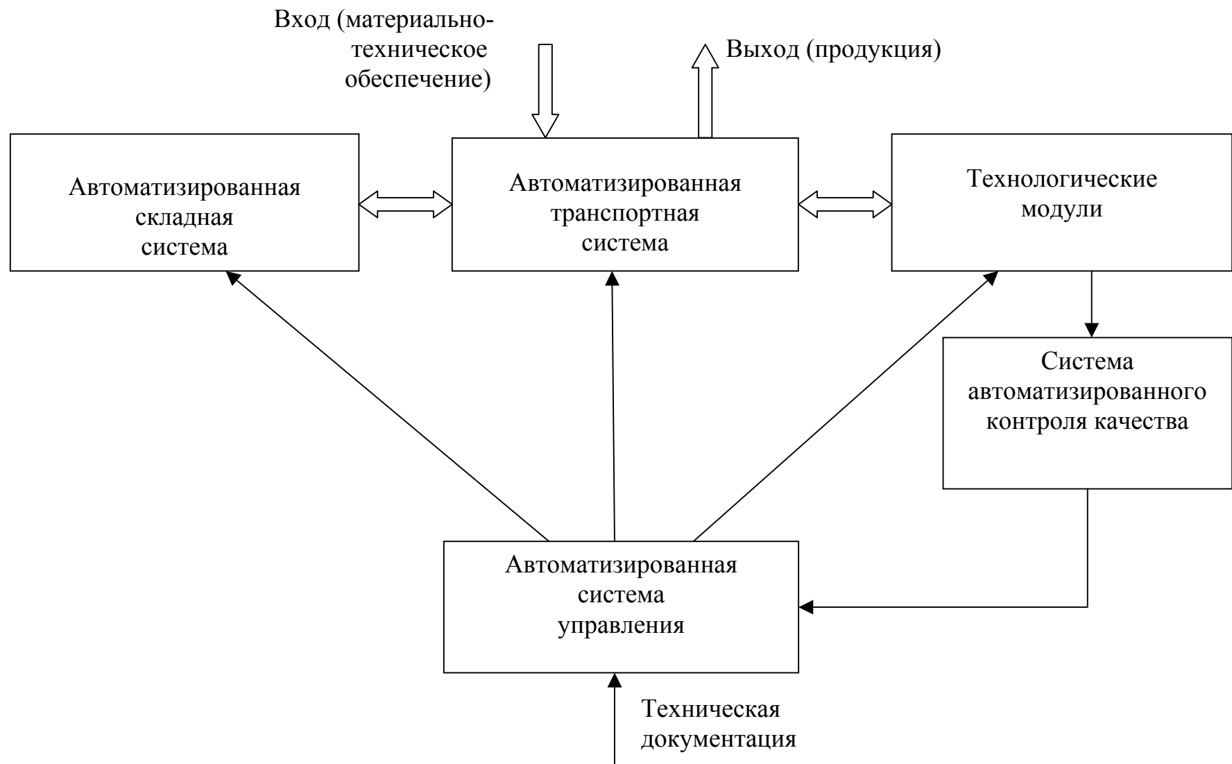
Рис. 7.1. Состав гибкой производственной системы. Двойными стрелками показаны материальные потоки.
