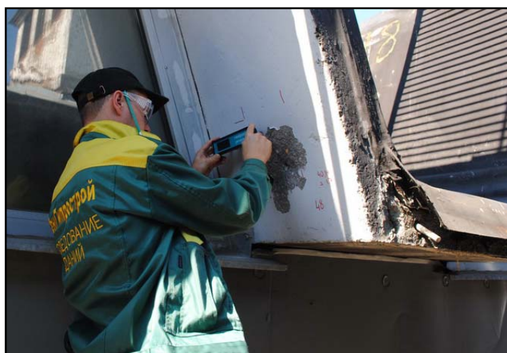
Рисунок 5. Измерение удельного электрического сопротивления бетона стенки складки
