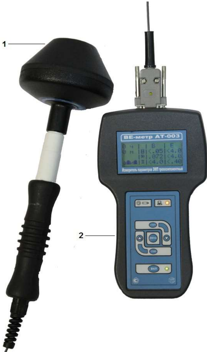
Рис. 7.2. Внешний вид измерителя. 1 – антенный блок, 2 – блок индикации
