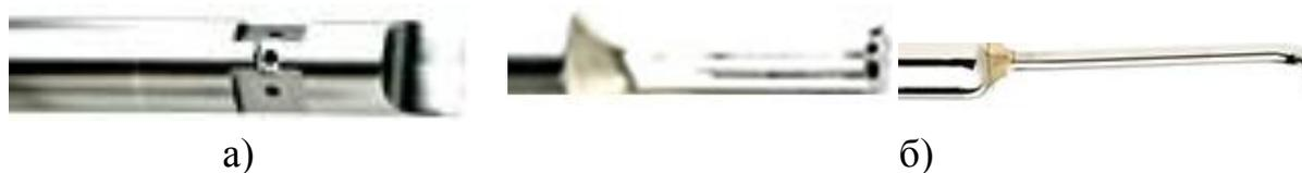
Рисунок 9 – Трехканальные пневмонасадки для измерения давлений  $p^*$ ,  $p$  и угла закрутки  $\alpha$  плоского потока: а) – для измерения параметров основного потока; б) для измерения параметров щелевого потока
