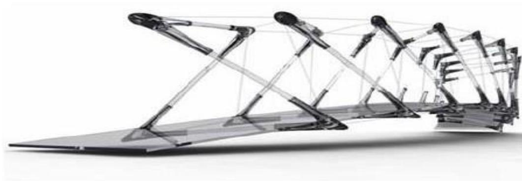
**Рисунок 17. Модель пролетного строения мостового сооружения по системе «тенсегрити»**
