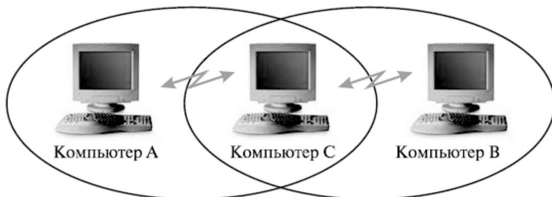
Рисунок 4.6 – Проблема скрытого терминала
