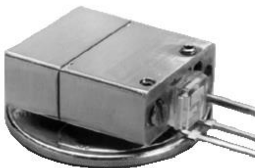
Рис.15. Физический блок миниатюрного КСЧ компании Westinghouse Electric Corp., 1992г [11]
