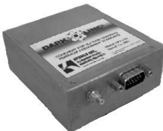
Рис. 19. Малогабаритный КСЧ КПН модель HPCC (KernCo) [15]
