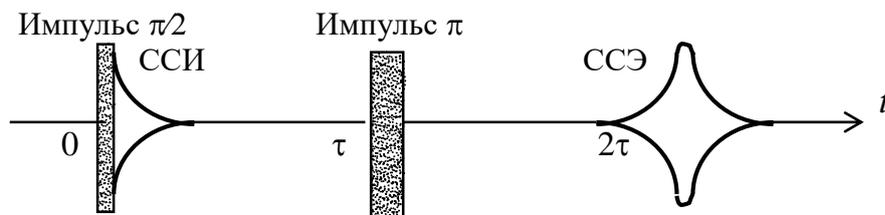
Рис. 10. Затухание сигналов свободной прецессии (ССП) и спинового эха (ССЭ) при действии на образец последовательности  $\pi/2$ – $\pi$  радиоимпульсов бесконечно малой длительности.
