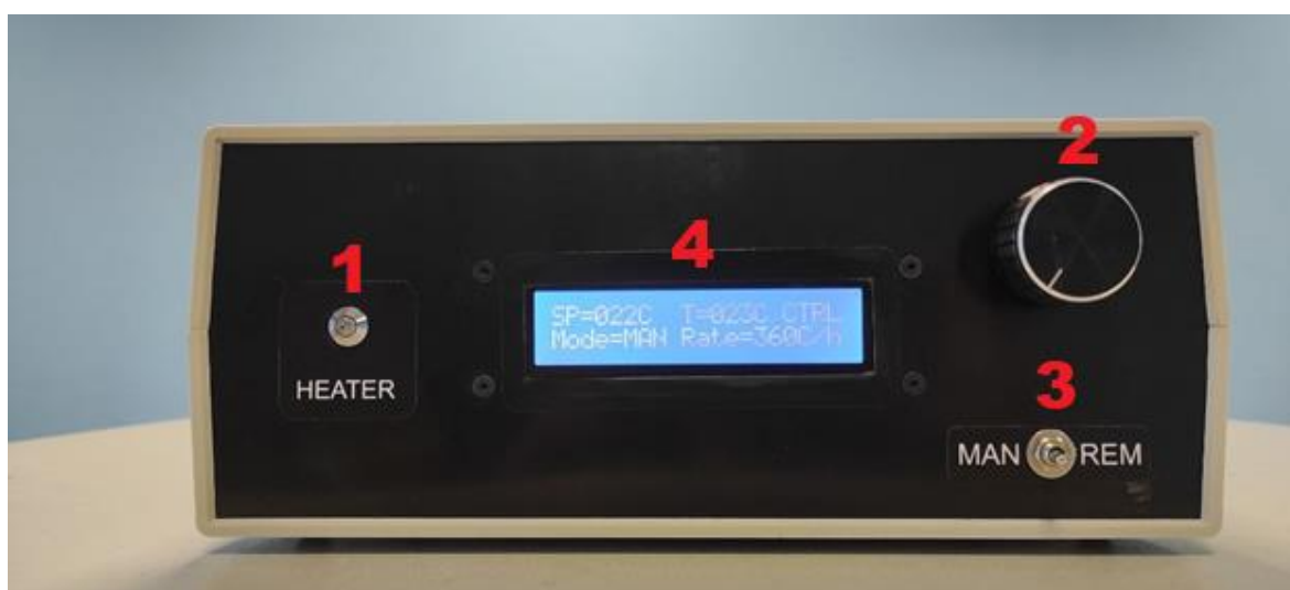
Рис. 21. Фотография лицевой панели термоконтроллера. На лицевой панели термоконтроллера располагаются: 1 – индикатор работы нагревателя; 2 – ручка установки температуры при работе в ручном режиме; 3 – переключатель режимов ручной/дистанционный; 4 – ЖК-дисплей.
