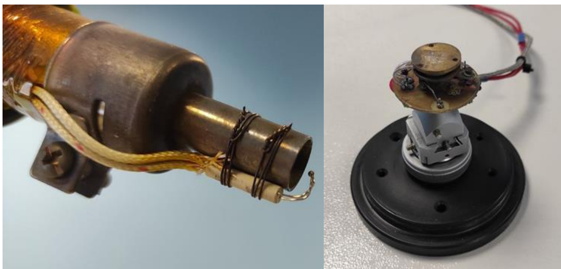
Рис. 25 Нагреватели образца обдувной (слева) контактный(справа).
