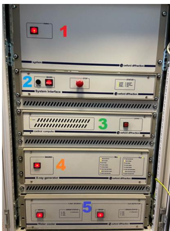
Рис. 5. 1 – Питание системы; 2 – Системный интерфейс; 3 – Компьютер; 4 – Генератор рентгеновских лучей; 5 – Водяное охлаждение и детектор.
