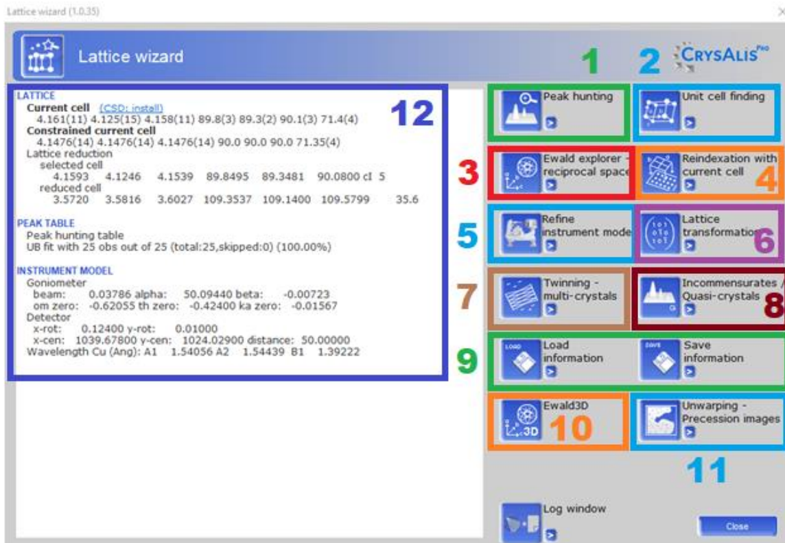
Рис. 13. Основной экран Lattice wizard. 1 – Инструмент работы с рефлексами; 2 – Инструмент определения матрицы ориентации элементарной ячейки кристалла; 3 – Инструмент просмотра обратного пространства; 4,5,6 – Инструменты уточнения матрицы ориентации; 7 – Поиск «двойников»; 8 – Инструмент, позволяющий расставить дополнительные (не-) соразмерные рефлексы; 9 – Загрузка и сохранение текущего этапа обработки; 10 – Еще один инструмент просмотра обратного пространства, появившийся в более поздних версиях CrysAlisPro, по своему функционалу отличается от 3; 11 – инструмент для просмотра срезов обратного пространства; 12 – Информационное окно.
