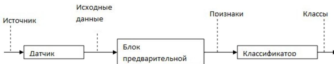
Рис.10. Структурная схема системы распознавания
