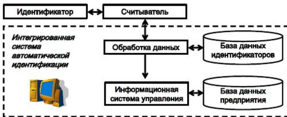
Рис. 2 Схема работы системы автоматической идентификации
