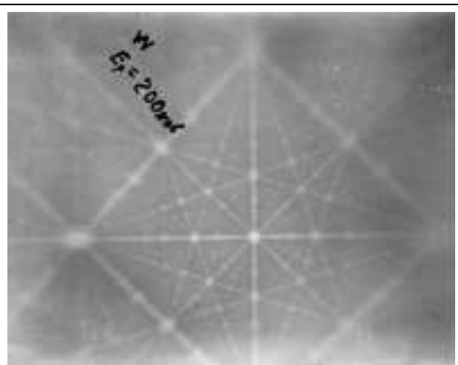
Рис. 13. Картина теней при рассеянии ускоренных протонов на большой угол от кристалла вольфрама (протонограмма) [15].
