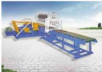
Рис. 4.5. Автомат для резки кирпича-сырца
