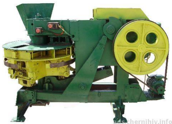
Рис. 4.6. Пресс для сухого прессования кирпича
