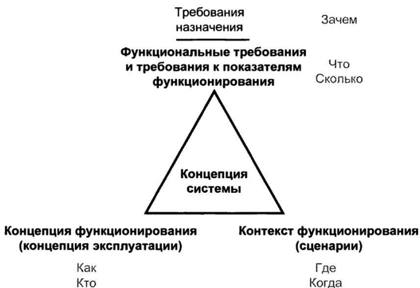
**Рис. 29** – Триединство разработки концепции системы [6].
