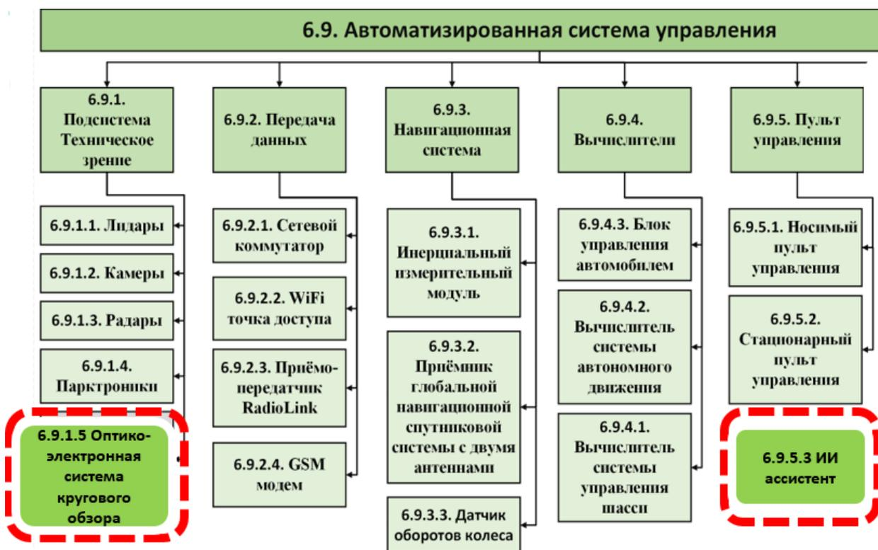
**Рис. 57** – Архитектура компонентов системы управления беспилотным транспортным средством.
