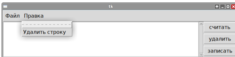
Рис. 11.10. Форма Tk, список ListBox , кнопки ttk.Button , линейка прокрутки ttk.Scrollbar , меню Menu .
