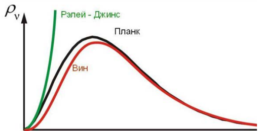
Рис. 1.9. Частотный спектр излучения абсолютно черного тела по версиям законов излучения Вина, Планка и Рэлея-Джинса
