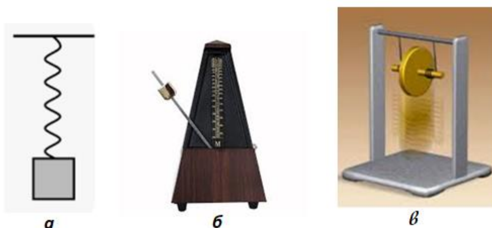
Рис. 1. Колебания тел при трех разных видах движения: а) поступательном – грузик на пружине; б) вращательном – маятник метронома; в) плоскопараллельном – маятник Максвелла.
