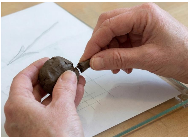
Рис. 12.9. Отделение комочка грунтового теста и его раскатка до жгута
