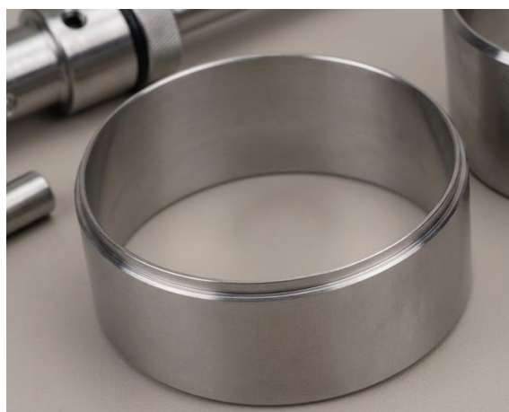
Рис. 7.2. Режущее кольцо с заточенной кромкой
