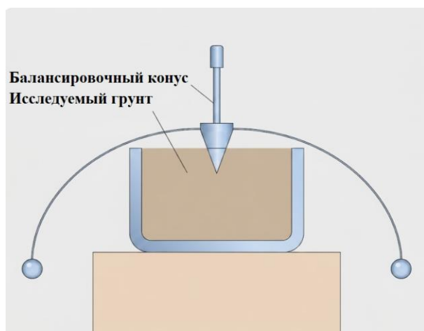
Рис. 12.2. Схема к определению влажности на границе текучести
