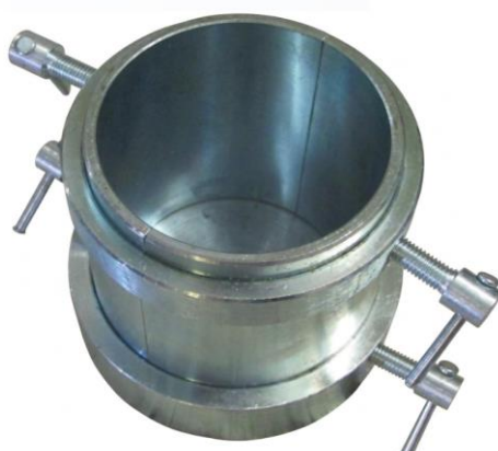
Рис. 5.6. Собранная форма для образца грунта
