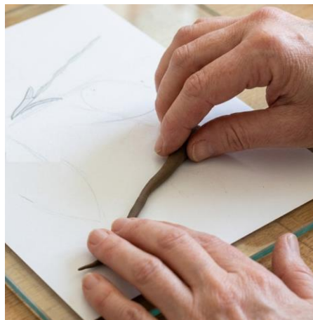
Рис. 12.9. Отделение комочка грунтового теста и его раскатка до жгута
