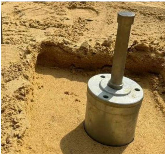
Рис. 5.2. Отбор пробы собранным прибором
