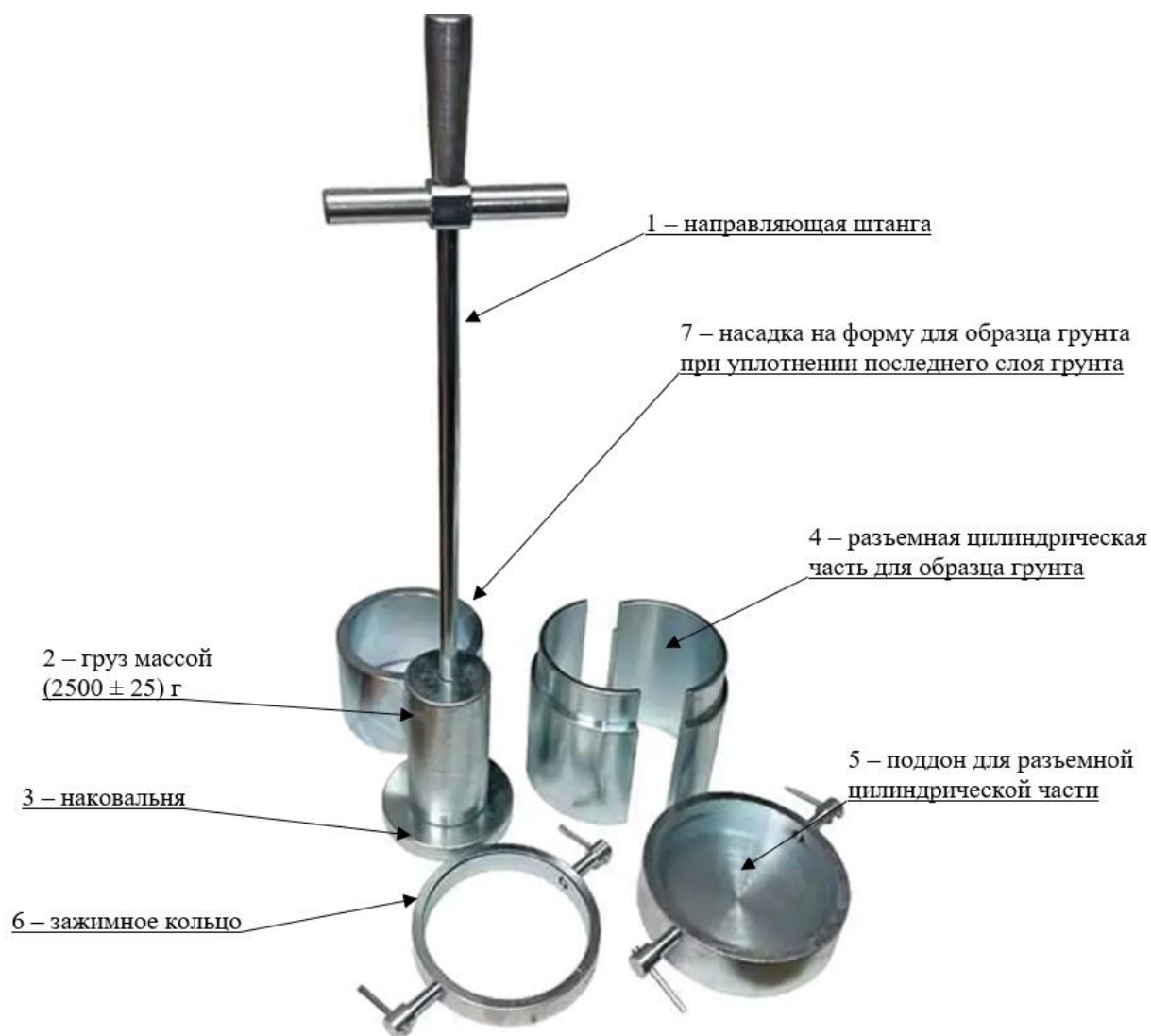
Рис. 5.5. Состав установки для испытания грунта методом стандартного уплотнения
