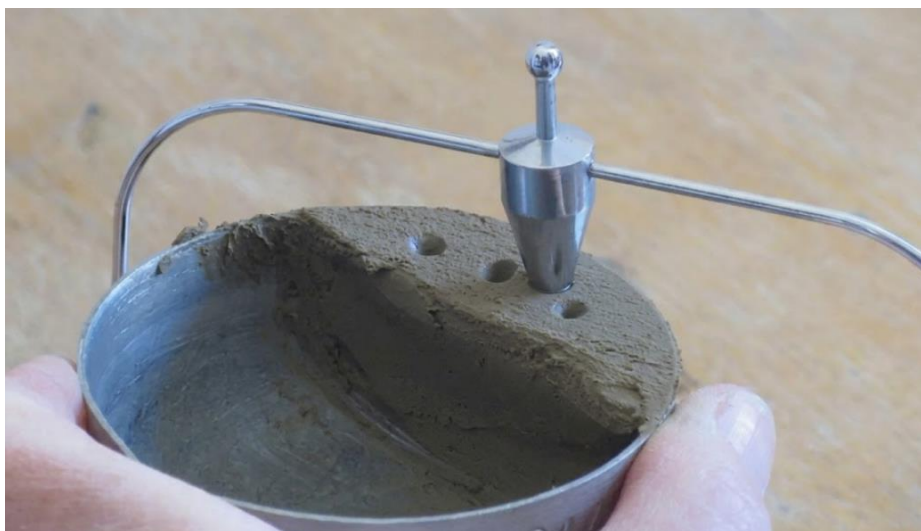
Рис. 12.8. Свободное погружение конуса в грунт под влиянием собственного веса
