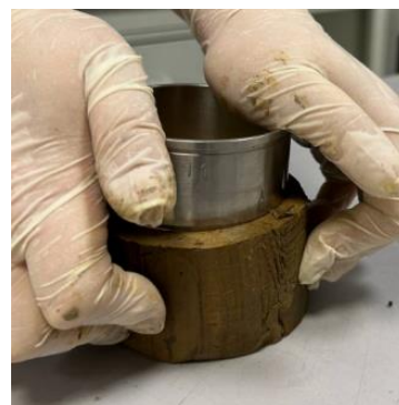
Рис. 7.3. Вдавливание кольца в грунт
