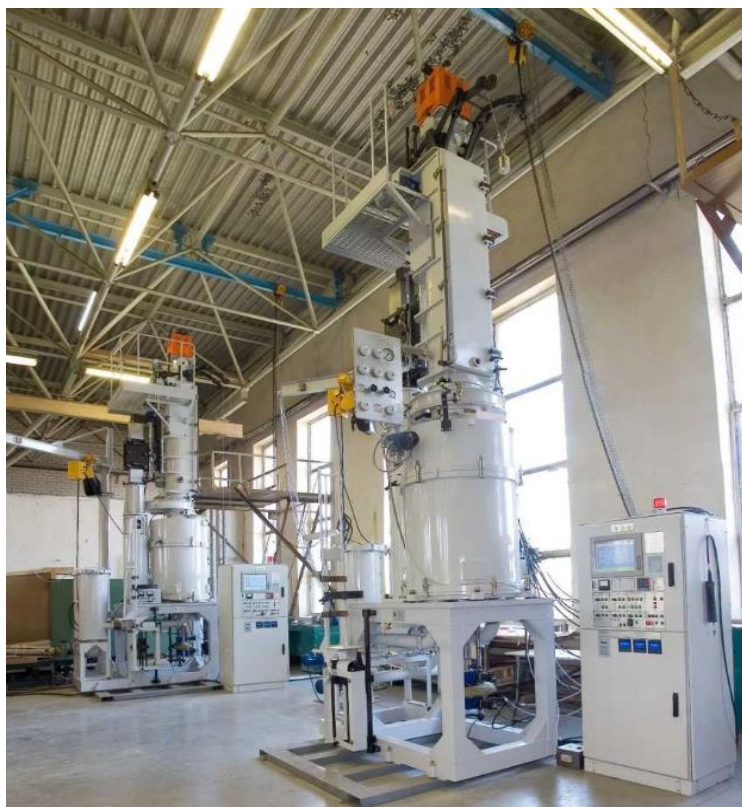
Рис. 76. Промышленная установка для выращивания монокристаллов кремния методом Чохральского
