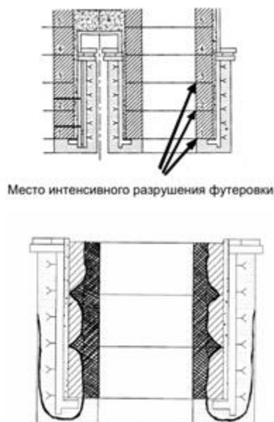
Рис.19. Износ футеровки патрубков вакуумной камеры циркуляционного вакууматора (1,0 мм / пл)
